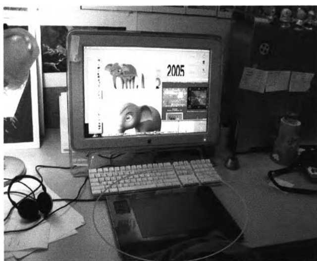
รูปที่ 4.11 ปากกาอิเล็กทรอนิกส์ – เม้าส์ปากกา (Tablet)
