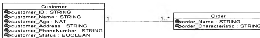
รูปที่ 3.21 ตัวอย่างความสัมพันธ์แอสโซซิเอชันระหว่างคลาส Customer กับคลาส Order
