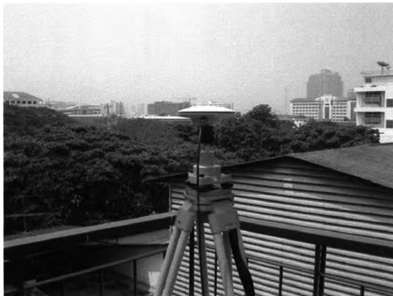
รูปที่ 3.1 เครื่องรับสัญญาณดาวเทียม Leica รุ่น SR530 ที่สถานี CU03 บนคาบศฟ้าศึกษาศาสตร์วิชานนิตศ บริเวณจุฬาลงกรณ์มหาวิทยาลัย
