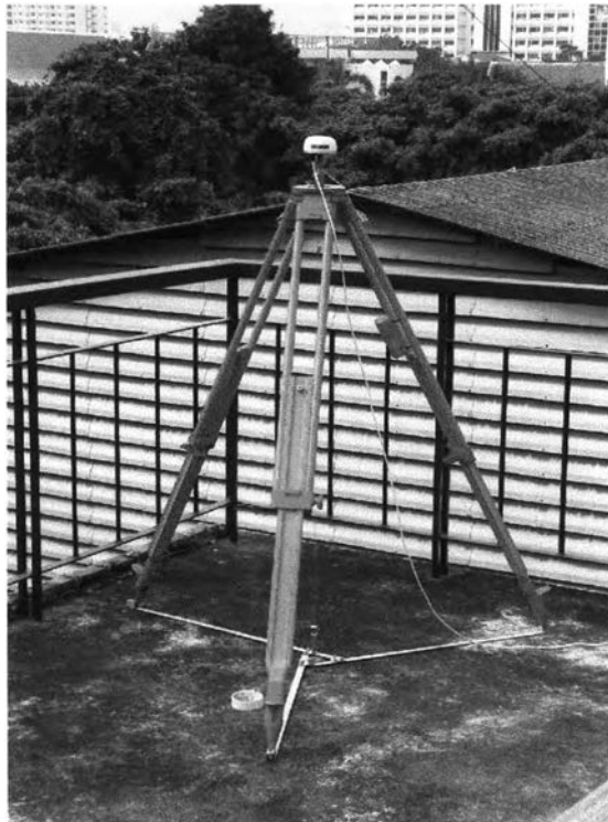
รูปที่ 3.2 ที่ตั้งเครื่องรับสัญญาณดาวเทียม Garmin รุ่น 12XL โดยใช้เสาอากาศภายนอก ที่สถานี CU03 บนคาบศฟ้าศึกษาศาสตร์วชิราวุฒินิเทศ บริเวณจุฬาลงกรณ์มหาวิทยาลัย
