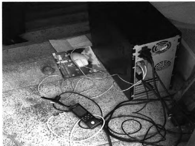
รูปที่ 3.5 แสดงการต่อเครื่องรับสัญญาณดาวเทียม GARMIN รุ่น 12XL โดยใช้เสาอากาศจากภายนอก กับเครื่องคอมพิวเตอร์ที่ใช้ในการจัดเก็บข้อมูลสัญญาณดาวเทียม
