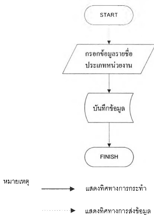
รูปที่ 4.32 ขั้นตอนการป้อนชื่อประเภทหน่วยงานรับตรวจ
