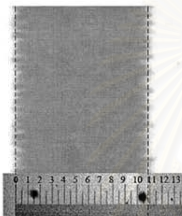
รูปที่ 4.56 ความกว้างของเส้นสีดำ ที่ซึมเข้าไปในสีเหลือง ของกระดาษที่ผลิตขึ้นจากสูตรที่ 1
