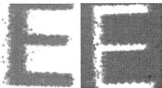
รูปที่ 4.23 ตัวอักษรขนาด 6 พอยท์ ของ กระดาษที่มีสัดส่วนของซิลิกาต่อดินขาวเป็น 75:25 และมีร้อยละของของแข็ง 22
