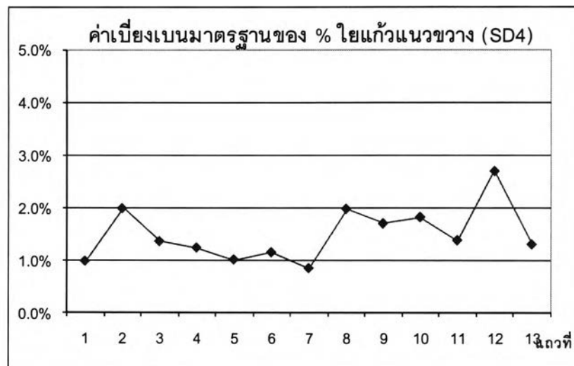
รูปที่ 3.19 ค่าเบี่ยงเบนมาตรฐานของปริมาณใยแก้วตามแนวขวางขึ้นตัวอย่างปกติ (SD4)
