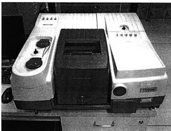
รูปที่ 3.5 เครื่อง fourier transform infrared spectrometer ของบริษัทเทอร์โม ไฮแอนทิฟิค จำกัด รุ่น Nicolet 6700
