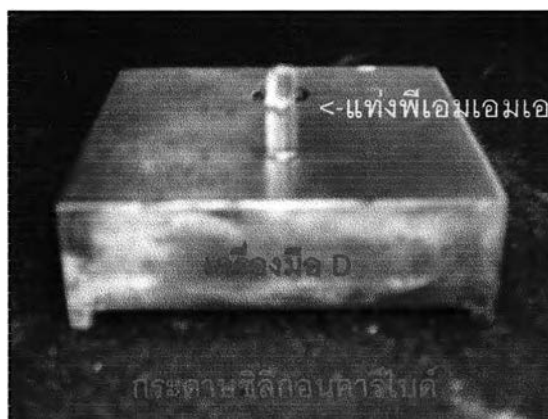
รูปที่ 6 รูปแสดงเครื่องมือ D และแท่งพีเอ็มเอ็มเอ เมื่อทำการขีดด้วยกระดาดซิลิกอนคาร์ไบด์
