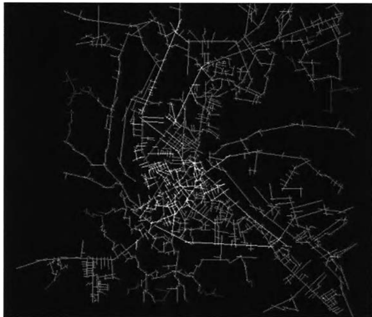
รูปที่ 2.18 การวิเคราะห์ศักยภาพในการเข้าถึงระดับพื้นที่เมือง (global integration analysis) ของเส้นทางต่างๆ ในโครงข่ายการสัญจร (spatial grid network) ของเมืองอุทัยธานี ด้วยโปรแกรม Space Syntax (ไชศรี ภัคดีสุขเจริญ, 2546)
