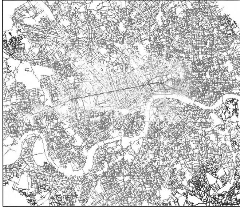
รูปที่ 2.19 การวิเคราะห์ศักยภาพในการเข้าถึงระดับพื้นที่เมือง (global integration analysis) ของเส้นทางต่างๆ ในโครงข่ายการสัญจร(spatial grid network) ของเมืองลอนดอน ด้วยโปรแกรม Space Syntax (Hillier,1996)
