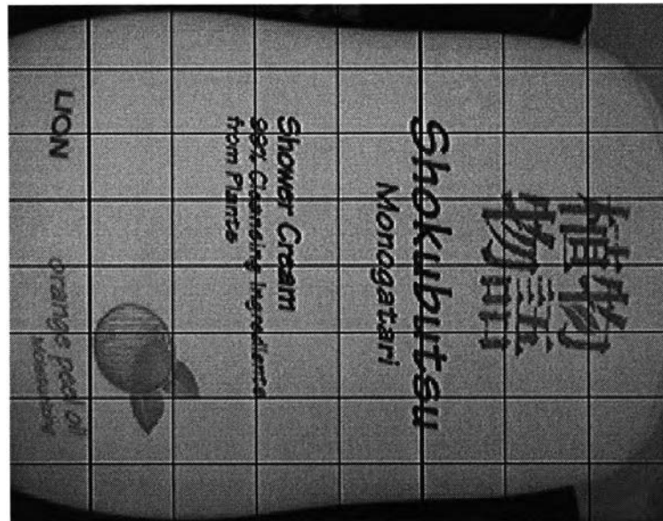
รูปที่ 4.2 ภาพที่ถูกแบ่งส่วนเป็น 64 ส่วน แต่ละส่วนมีขนาด 90 x 72 พิกเซล
