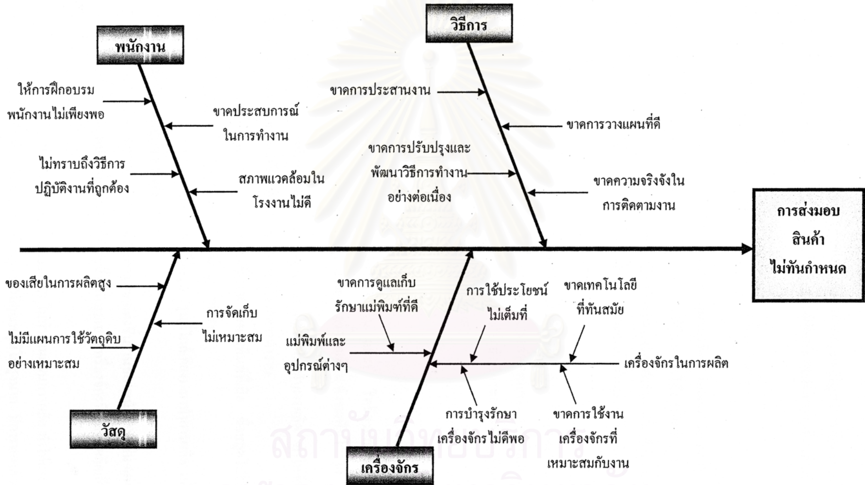
รูปที่ 3.10 แผนภูมิการหาสาเหตุของปัญหาการส่งมอบไม่ทันกำหนด
