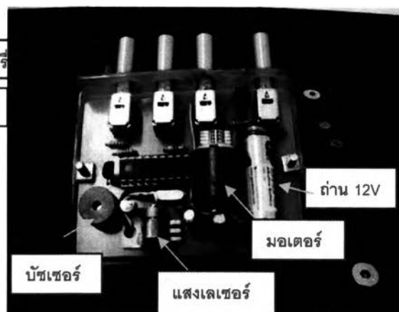
รูปที่ 3.15 แสดงวงจรภายใน
