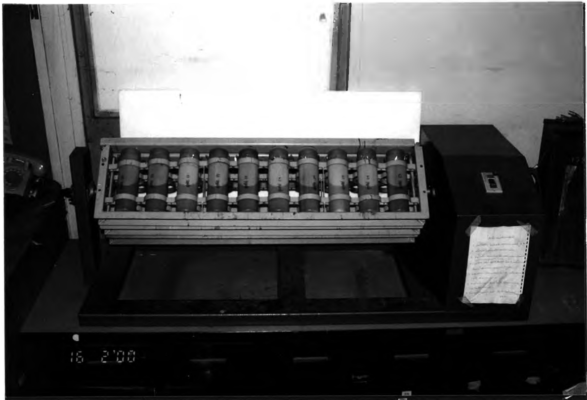
รูปที่ 4.3 เครื่องกวนเขย่าหมุน(Rotary agitator)
