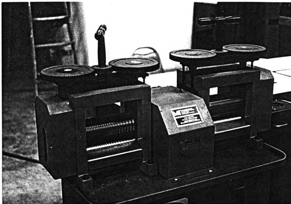
ภาพที่ 3.3 แสดงเครื่องรีดลดขนาดเป็นเส้นลวดที่ใช้ในการทดลอง
