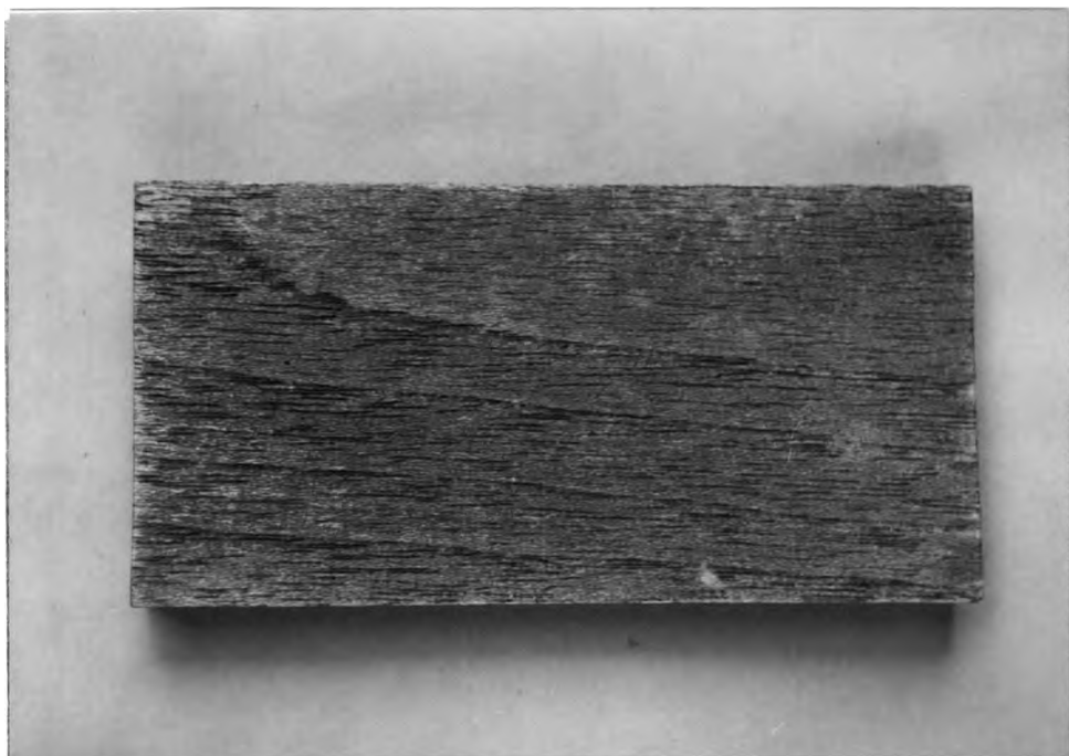
รูปที่ 4.13 การชำรุดในเดือนที่ 8 เมื่อทาอะคริลิกแลกเกอร์ 1 ชั้น (วิธีธรรมชาติ)
