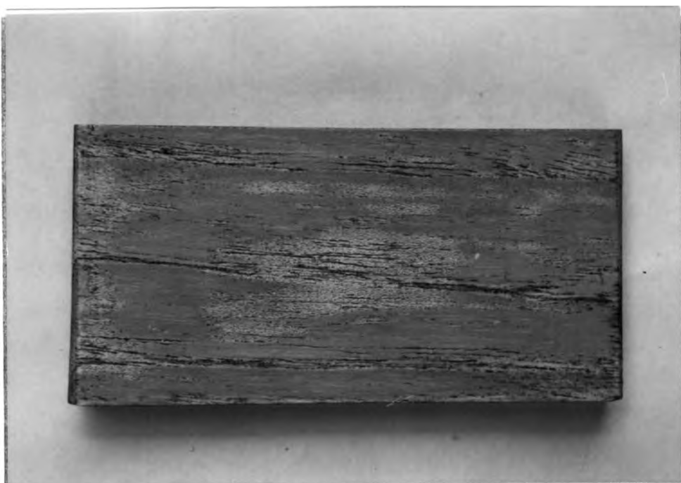
รูปที่ 4.18 การชำรุดในเดือนที่ 8 เมื่อทาอะคริลิกแลกเกอร์ที่ใส่ยูวีสเตบิไลเซอร์ 3 ชั้น (วิธีธรรมชาติ)
