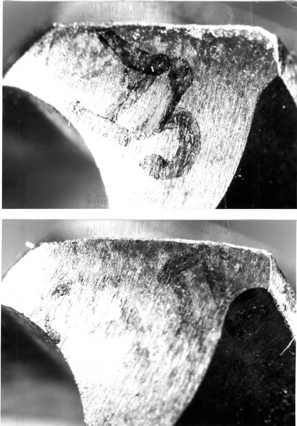
รูปที่ ค.10 ความสึกหรอของดอกสว่านซึ่งทำการเจาะมาแล้ว 400 รูเจาะ ด้วยอัตราการป้อน 0.2 มิลลิเมตรต่อรอบ และ อัตราเร็วรอบ 710 รอบต่อนาที
