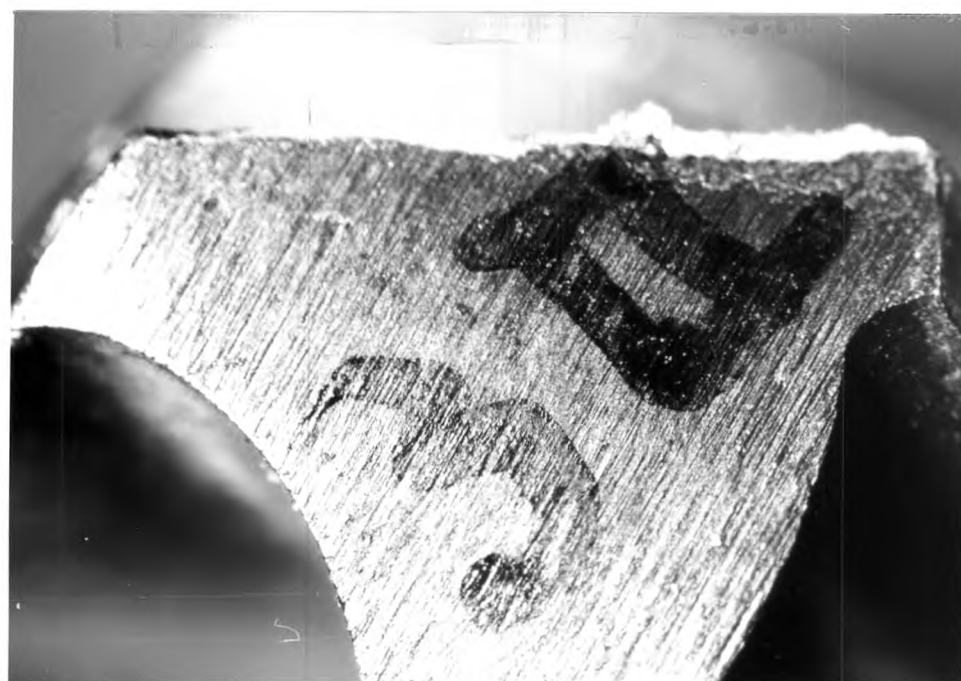
รูปที่ ค.8 ความสึกหรอของดอกสว่านซึ่งทำการเจาะมาแล้ว 400 รูเจาะ ด้วยอัตราการป้อน 0.12 มิลลิเมตรต่อรอบ และ อัตราเร็วรอบ 710 รอบต่อนาที
