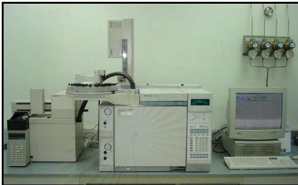
รูปที่ ๑-1 เครื่อง Gas Chromatography รุ่น HP 6890
