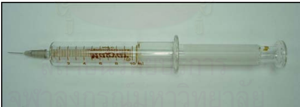
รูปที่ ข-8 ไชริง (Glass Syringes) ขนาด 20 มิลลิลิตร ใช้สำหรับการเติมออกซิเจน
