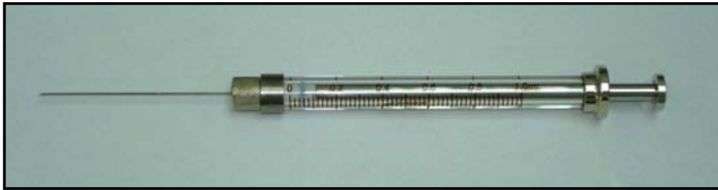
รูปที่ ข-6 ไชริง (GasTight Syringes) ขนาด 1 มิลลิลิตร ใช้สำหรับการเก็บตัวอย่างมาวิเคราะห์
