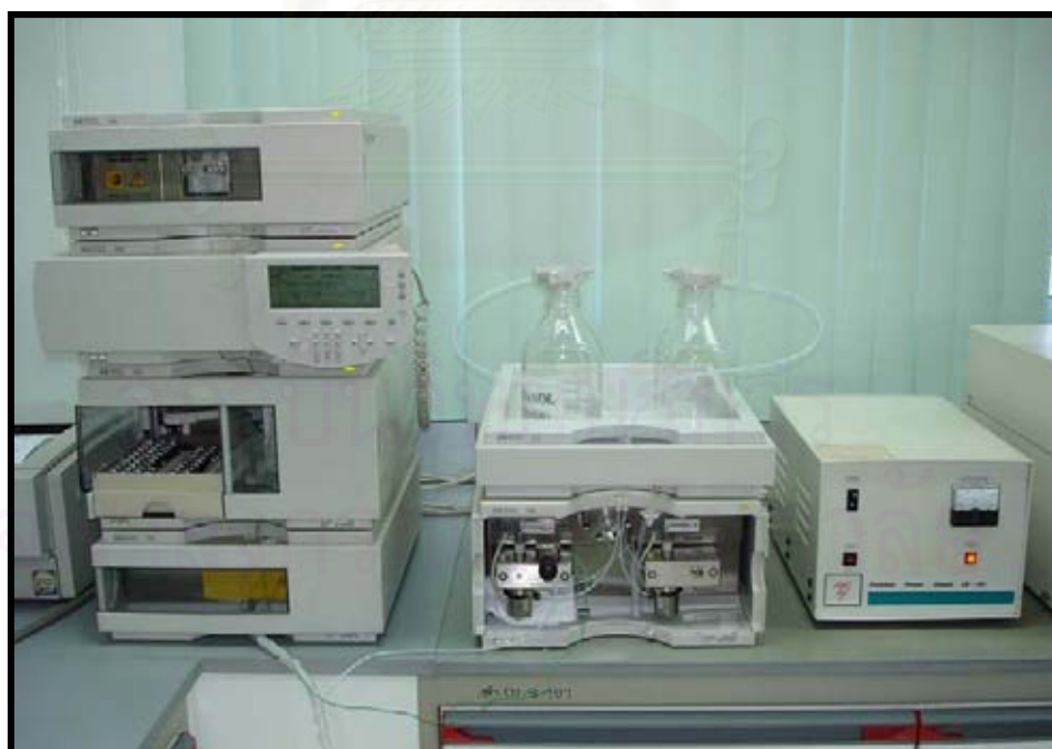
รูปที่ ๑-2 เครื่อง High Performance Liquid Chromatography รุ่น HPLC 1100
