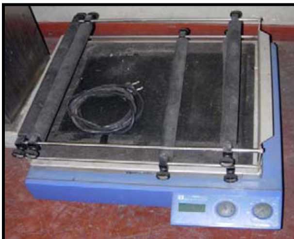
รูปที่ ข-10 เครื่องเขย่า (Shaker) ที่ทำการเขย่าขวดซีรัมตลอดเวลาการทดลอง
