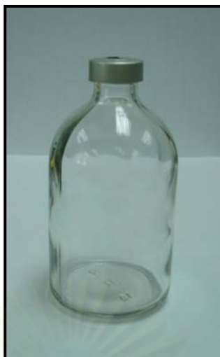
รูปที่ ข-3 ขวดซีรัมขนาด 119 มิลลิลิตร (Serum Bottle) ที่ใช้ในการทดลอง
