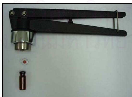
รูปที่ ข-5 ขวดไวอัล (Vial)ขนาด 2 มิลลิลิตร และอุปกรณ์ปิดฝาที่ใช้สำหรับเครื่อง
