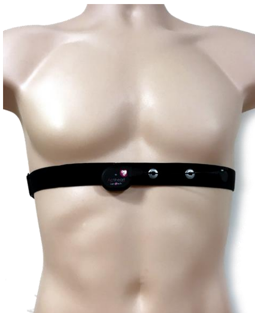
รูปที่ 11 ตำแหน่งในการติดตั้ง Actiheart (ที่มา: https://www.camntech.com )
