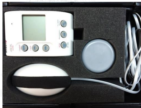
เครื่องมือทดสอบความแข็งแรงของกล้ามเนื้อขา แฮนด์ ฮิล ไดนาโมมิเตอร์ (Hand-held dynamometer)
