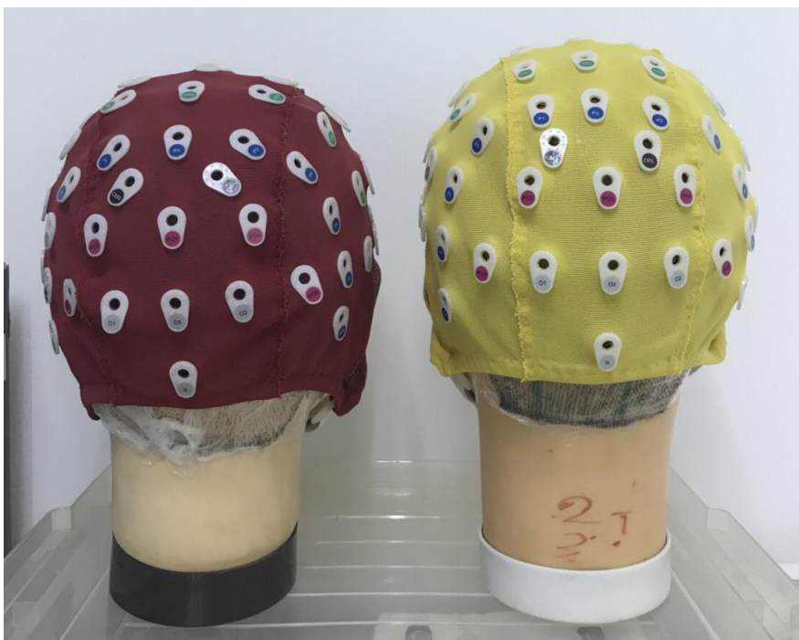
ภาพที่ 2 แสดงการจัดเรียงอิเล็กโทรดตามวิธีมาตรฐานสากลระบบ 10 – 20
