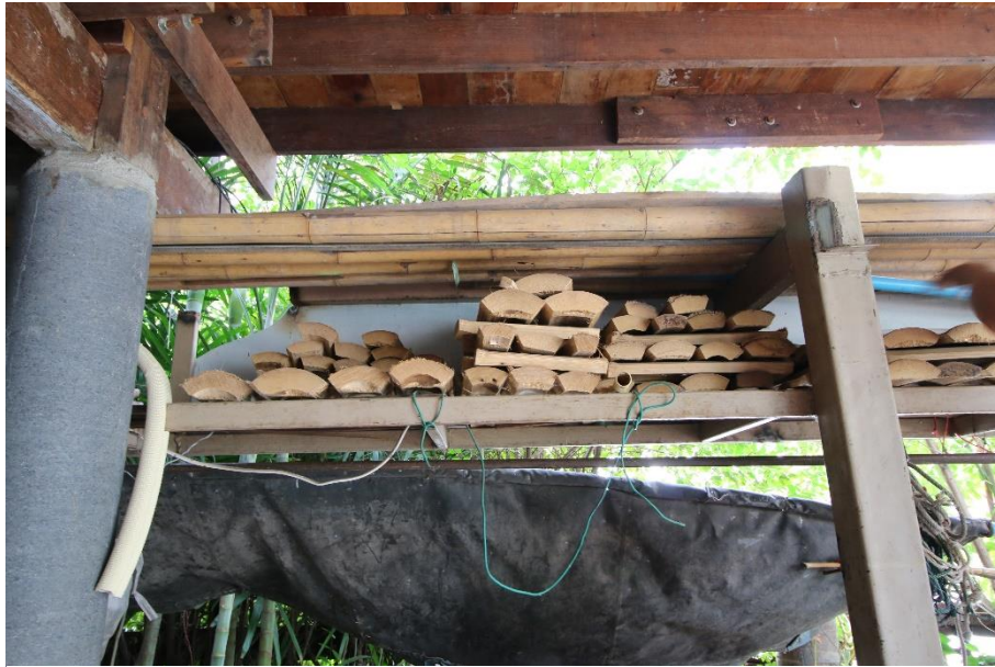
ภาพที่ 53 การผึ่งไม้ไผ่ไว้บนชั้น ที่มา: ปรีทศน์ เรืองยิ้ม วันที่ 15 มิถุนายน 2563
