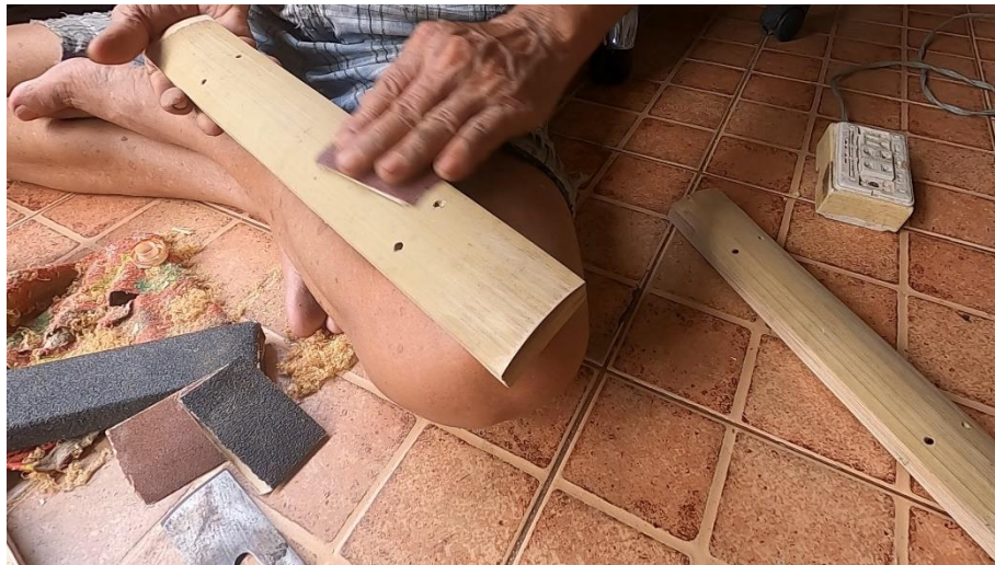
ภาพที่ 119 การใช้กระดาษทรายเบอร์ละเอียดขัดบนลูกระนาดท่อม ที่มา: ปรีทศน์ เรืองยิ้ม วันที่ 15 มิถุนายน 2563
