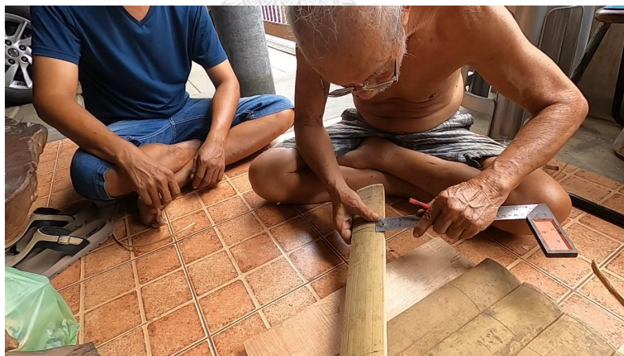
ภาพที่ 91 การหาจุดเจาะรื้อยเชือกโดยวัดจากข้างลูกเข้ามาตรงกลางข้างละ 1.5 เซนติเมตร ที่มา: ปรีทัศน์ เรืองยิ้ม วันที่ 15 มิถุนายน 2563
