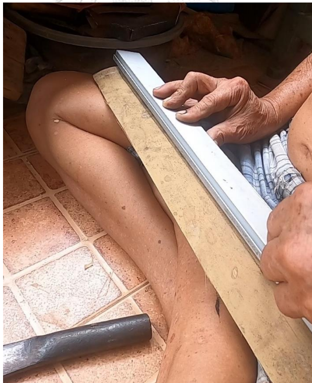
ภาพที่ 58 การวัดความกว้างของลูกระนาดท่อม โดยไม้บรรทัดเป็นเครื่องมือในการวัด และใช้ดินสอทำสัญลักษณ์ไว้ทั้งสองด้าน ที่มา: ปรีทศน์ เรืองยิ้ม วันที่ 15 มิถุนายน 2563
