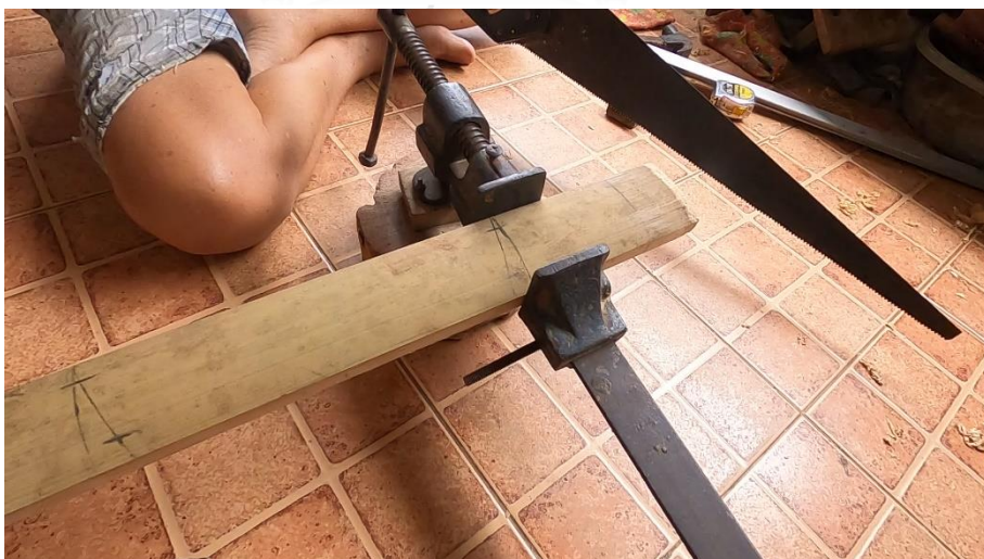
ภาพที่ 93 การนำลูกธนูขนาดท่อมแต่ละลูกมาตัด โดยใช้แม่แรงอัดพื้นช่วยจับลูกธนูขนาดท่อม ที่มา: ปรีทัศน์ เรืองยิ้ม วันที่ 15 มิถุนายน 2563
