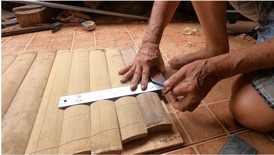
ภาพที่ 87 การหาตำแหน่งรูร้อยเชือกโดยวัดจากเส้นที่ขีดไว้เข้ามาตรงกลางลูก ที่มา: ปรีทศน์ เรืองยิ้ม วันที่ 15 มิถุนายน 2563
