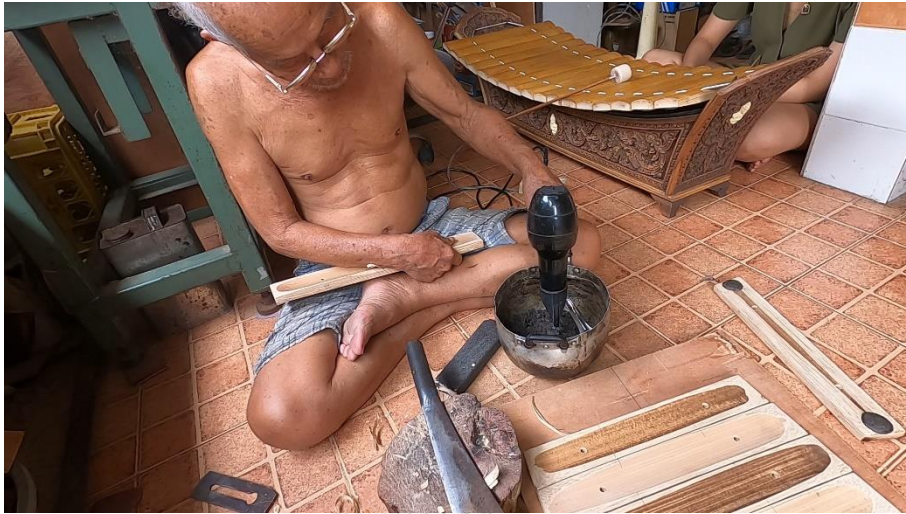
ภาพที่ 114 การนำไต้รเป่ามมาเป่าตะกั่วให้ร้อนจนละลาย ที่มา: ปรีทศน์ เรืองยิ้ม วันที่ 15 มิถุนายน 2563
