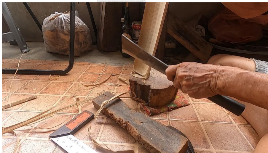
ภาพที่ 61 การผ่าในบริเวณข้อของลูกระนาดทุม เพื่อให้ข้อตรงสวยงาม ที่มา: ปรีทัศน์ เรืองยิ้ม วันที่ 15 มิถุนายน 2563
