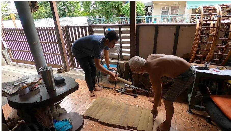
ภาพที่ 76 การนำลูกกระขนาดท่อมลูกที่ 1-17 ลูก มาวางเรียงไว้บนไม้อัดที่มีเส้นตรงขีดไว้ตรงกลาง ที่มา: ปรีทศน์ เรืองยิ้ม วันที่ 15 มิถุนายน 2563
