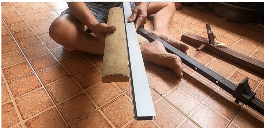
ภาพที่ 68 การนำไม้บรรทัดที่มีขนาดยาวมาทาบลูกระนาดทึ่ม โดยสังเกตว่าตรงเท่ากันทั้งลูกหรือไม่ ที่มา: ปรีทศน์ เรืองยิ้ม วันที่ 15 มิถุนายน 2563
