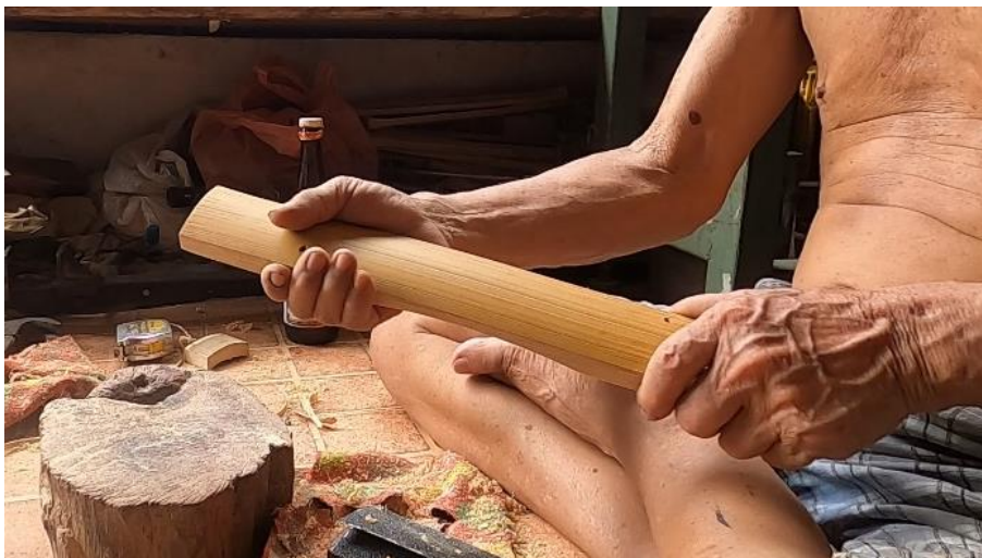
ภาพที่ 125 การตรวจความเรียบร้อยโดยการเอามือมาลูบลูกระนาดทุ้มทั้งลูก ที่มา: ปรีทศน์ เรืองยิ้ม วันที่ 15 มิถุนายน 2563
