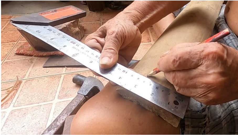
ภาพที่ 57 การนำไม้บรรทัดที่มีขนาดยาวมาทาบบนลูกระนาดท่อม แล้วใช้ดินสอขีดเส้นให้ตรงตามขนาดที่ได้วัดไว้ ที่มา: ปรีทศน์ เรืองยิ้ม วันที่ 15 มิถุนายน 2563
