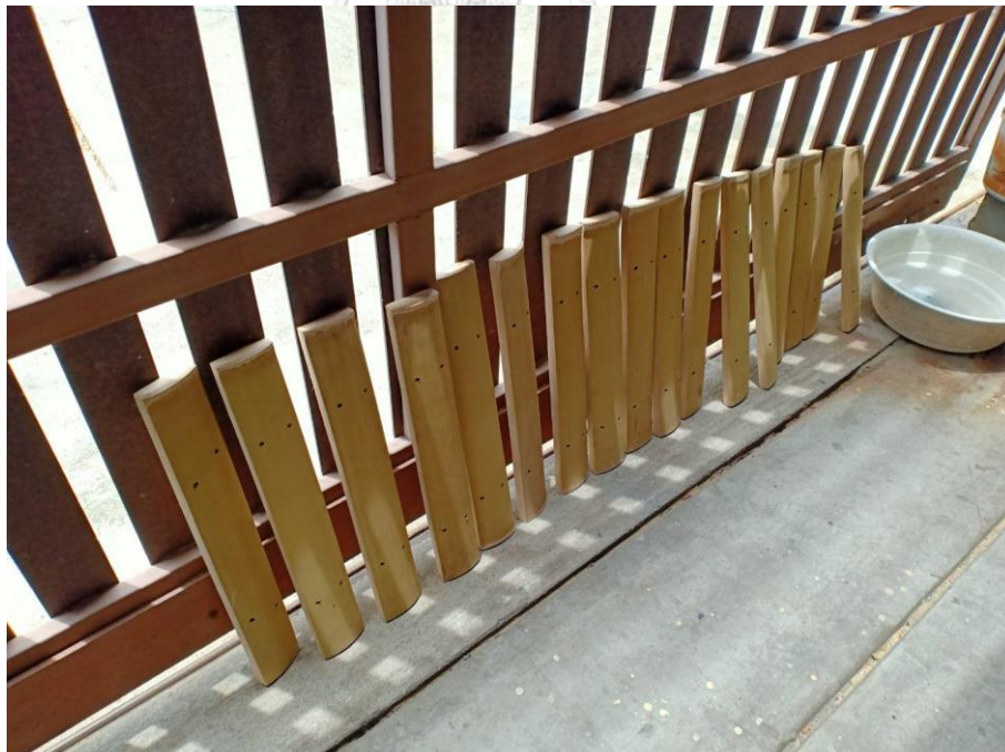
ภาพที่ 105 การนำลูกกระนาคหุ้มผึ่งไว้ที่ร่มประมาณ 1-2 ชั่วโมงหรือจนกว่าจะแห้ง ที่มา: ปรีทัศน์ เรืองยิ้ม วันที่ 15 มิถุนายน 2563
