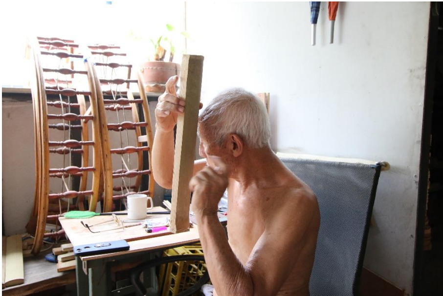
ภาพที่ 55 ช่างฉะโอด บุญจันทร์ กำลังคัดไม้ไผ่โดยการเคาะเพื่อฟังเสียง
