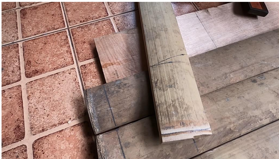
ภาพที่ 90 การเปลี่ยนตำแหน่งรื้อยเชือกเฉพาะลูกที่ 1 ทำมุมเอียงเข้ามา 1.5 เซนติเมตร ที่มา: ปรีทัศน์ เรืองยิ้ม วันที่ 15 มิถุนายน 2563
