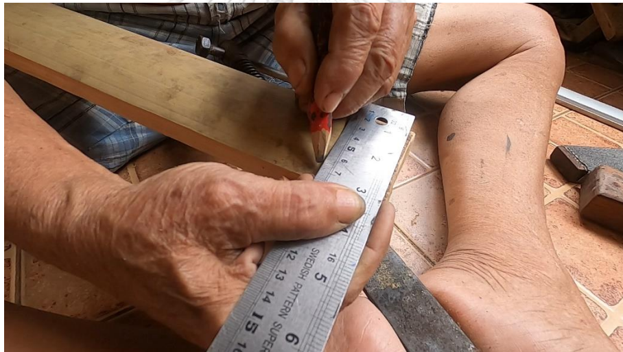
ภาพที่ 70 การกำหนดความกว้างของลูกกระนาตทุ้ม ที่มา: ปรีทศน์ เรืองยิ้ม วันที่ 15 มิถุนายน 2563
