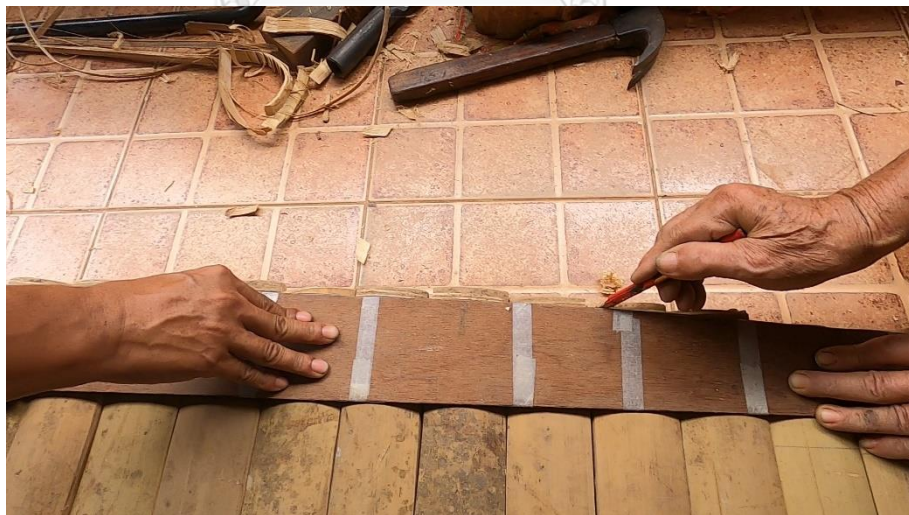
ภาพที่ 86 การใช้ดินสอขีดเส้นเพื่อทำสัญลักษณ์ในการตัดลูกระนาดหุ้ม ที่มา: ปรีทศน์ เรืองยิ้ม วันที่ 15 มิถุนายน 2563
