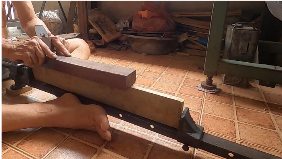
ภาพที่ 67 การนำลูกระนาดทึ่มมาไสด้านข้างโดยใช้กบบรรทัดเป็นเครื่องมือในการไส ที่มา: ปรีทศน์ เรืองยิ้ม วันที่ 15 มิถุนายน 2563
