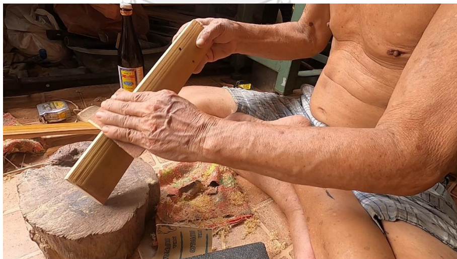
ภาพที่ 124 การใช้กระดาษทรายเบอร์ละเอียดเพื่อลบคมลูกกระขนาดทும் ที่มา: ปรีทัศน์ เรืองยิ้ม วันที่ 15 มิถุนายน 2563
