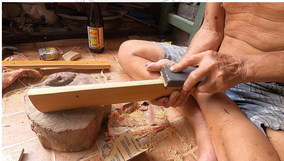
ภาพที่ 122 การใช้กระดาษทรายเบอร์หยาบขัดคราบสีแชล็ค ที่มา: ปรีทัศน์ เรืองยิ้ม วันที่ 15 มิถุนายน 2563
