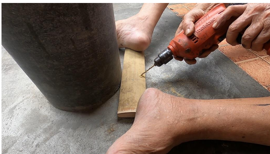
ภาพที่ 101 การเจาะบนลูกโดยทำมุมเฉียงเพื่อให้ทะลุไปหาตำแหน่งของรูใต้เชือก ที่มา: ปรีทศน์ เรืองยิ้ม วันที่ 15 มิถุนายน 2563
