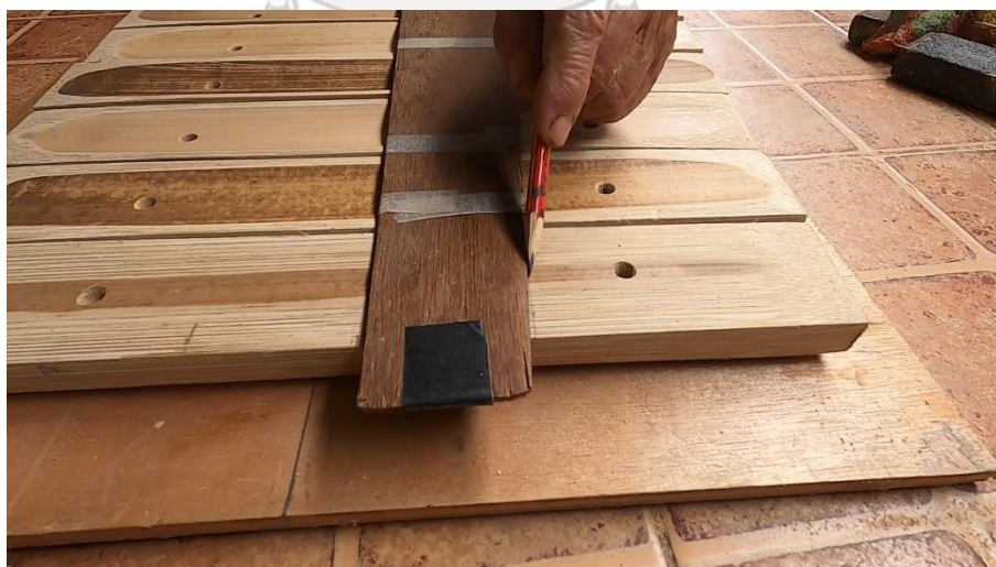
ภาพที่ 110 การใช้ดินสอขีดเส้นเพื่อทำสัญลักษณ์ตำแหน่งปาดท้องลูกธนูขนาดทุ้มทั้ง 17 ลูก ที่มา: ปรีทศน์ เรืองยิ้ม วันที่ 15 มิถุนายน 2563
