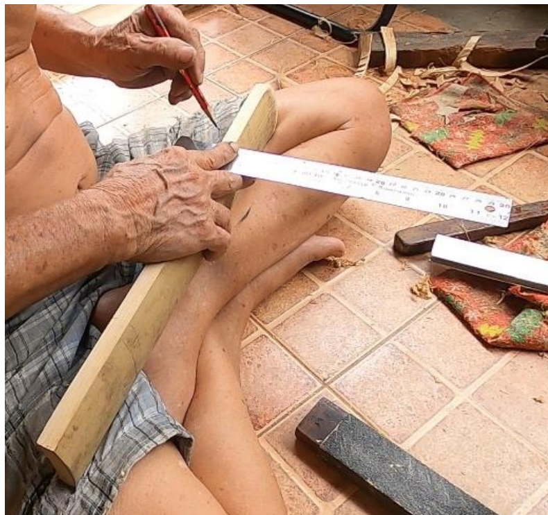
ภาพที่ 96 การใช้ไม้บรรทัดทาปไว้บริเวณข้างลูกและใช้ดินสอขีดเส้นไว้ทั้งสองด้าน ที่มา: ปรีทัศน์ เรืองยิ้ม วันที่ 15 มิถุนายน 2563
