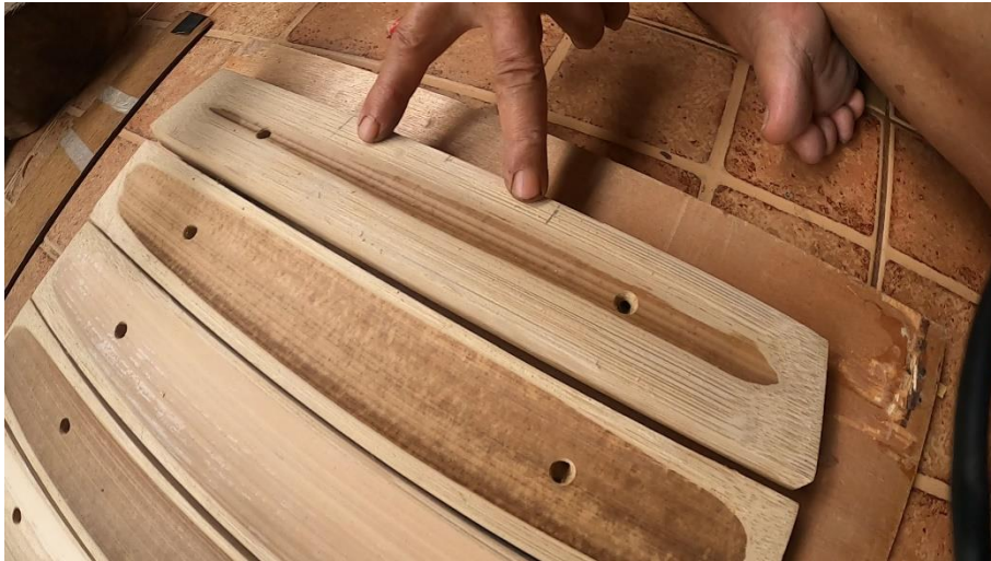
ภาพที่ 107 ลูกที่ 17 วัดออกไปด้านข้างจากจุดกึ่งกลาง ข้างละ 4.5 เซนติเมตร ที่มา: ปรีทศน์ เรืองยิ้ม วันที่ 15 มิถุนายน 2563
