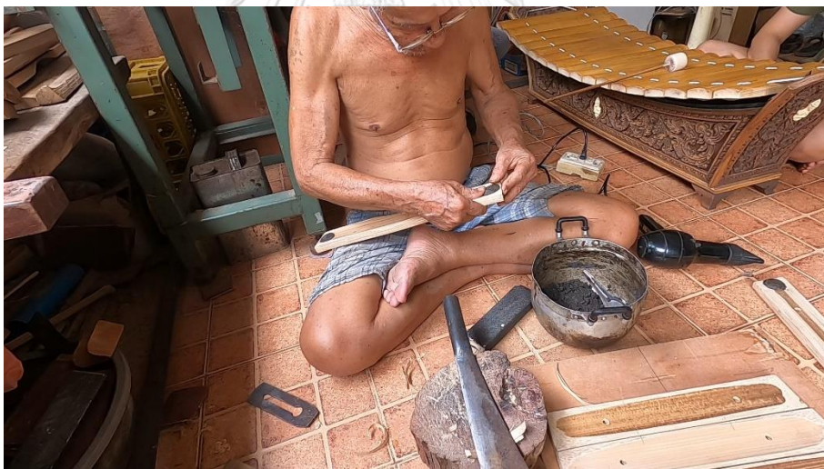
ภาพที่ 115 การนำตะกั่วมาติดที่ใต้ลูกกระนาคทุ้ม ที่มา: ปรีทศน์ เรืองยิ้ม วันที่ 15 มิถุนายน 2563
