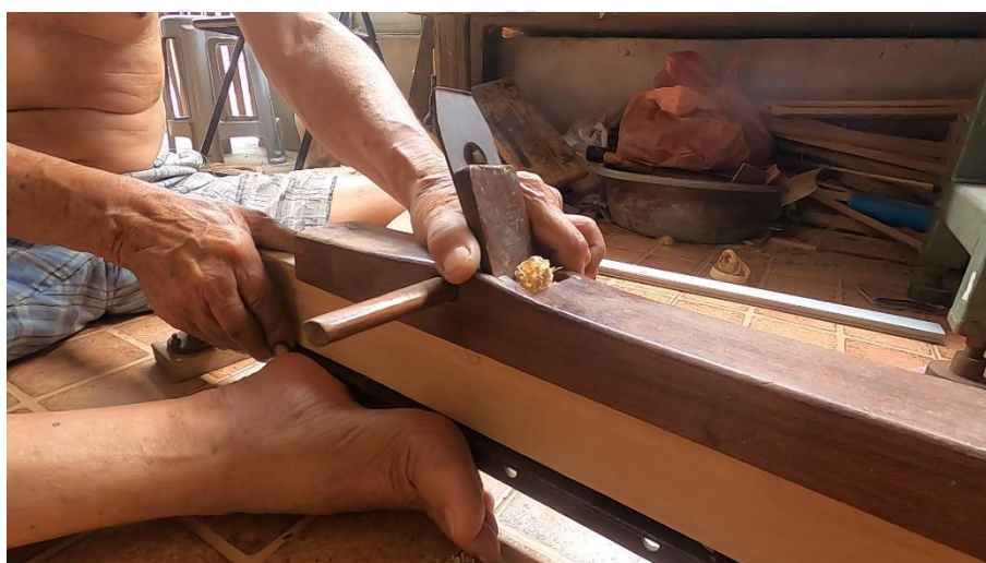
ภาพที่ 74 การนำลูกระนาดท่อมมาไสด้านข้างอีกครั้ง เพื่อให้เรียบและตรงยิ่งขึ้น
