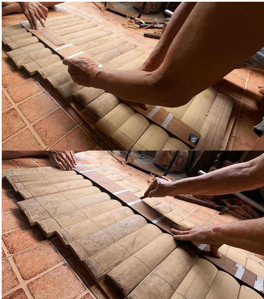
ภาพที่ 89 การนำกระสวนวางไว้บนลูกกระขนาดท่อม เพื่อทำสัญลักษณ์ตำแหน่งร้อยเชือกทั้ง 17 ลูก ที่มา: ปรีทัศน์ เรืองยิ้ม วันที่ 15 มิถุนายน 2563
