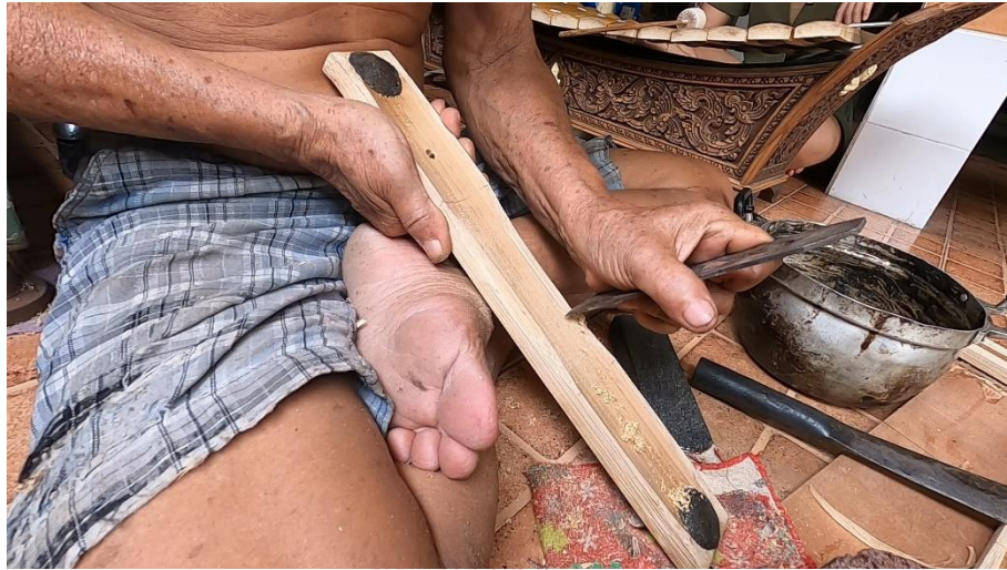
ภาพที่ 116 การใช้ใบมีดกดไสไม้มาขูดภายในเส้นที่ขีดไว้ ที่มา: ปรีทศน์ เรืองยิ้ม วันที่ 15 มิถุนายน 2563
