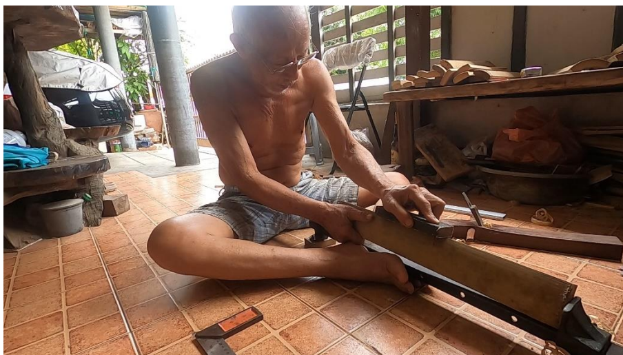
ภาพที่ 69 การนำกระดาษทรายเบอร์หยาบมาขัดอีกรอบเพื่อความเรียบร้อย
