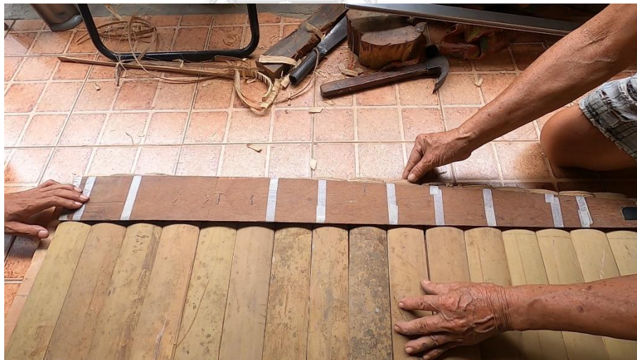
ภาพที่ 84 การนำกระสวนมาวางบนลู่กระขนาดท่อมทั้ง 17 ลู่ และจัดลู่กระขนาดท่อมลู่ที่ 2-16 ให้พอดีกับลู่ที่ 1 และลู่ที่ 17 ที่มา: ปรีทัศน์ เรืองยิ้ม วันที่ 15 มิถุนายน 2563
