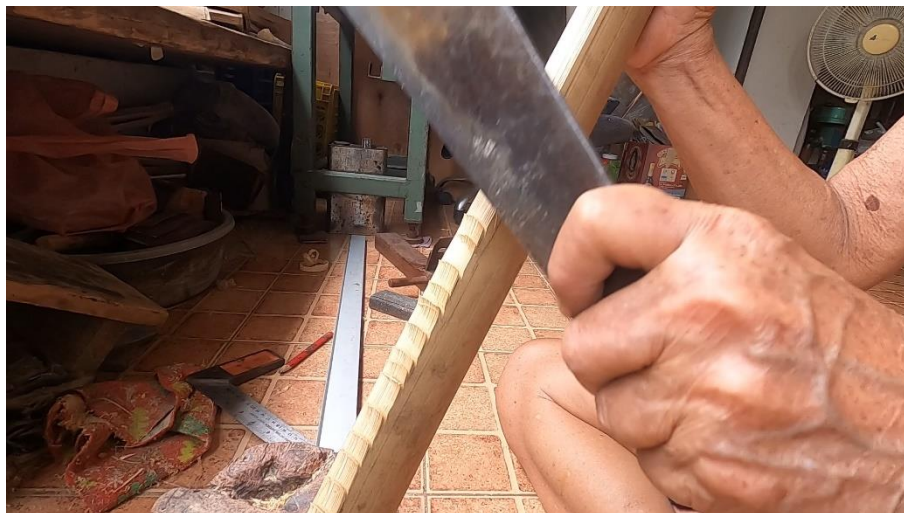
ภาพที่ 73 การใช้มีดสับข้างลูกระนาดท่อมไปเรื่อย ๆ จนใกล้กับเส้นที่ได้ขีดไว้
