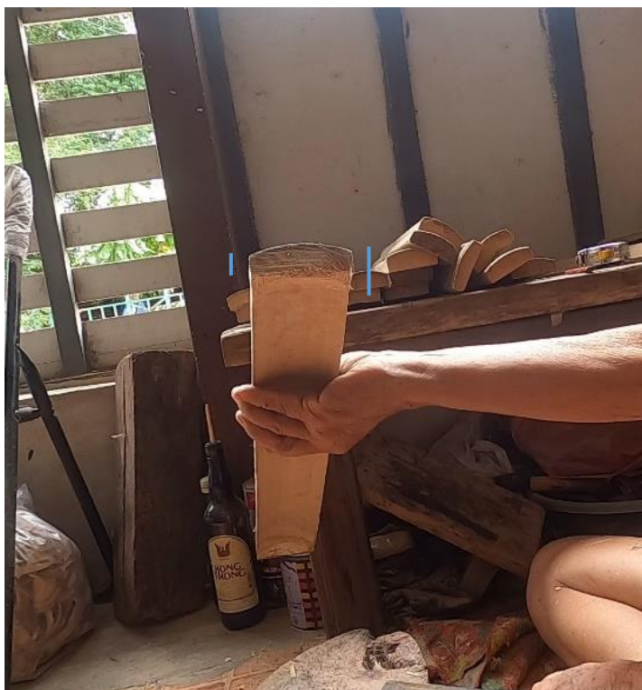
ภาพที่ 66 หลังการตกแต่งในส่วนของด้านข้างของลูกระนาดท่อม สามารถสังเกตได้ว่าข้าง ๆ ลูกระนาดท่อมจะตรงสวยงามขึ้น ที่มา: ปรีทัศน์ เรืองยิ้ม วันที่ 15 มิถุนายน 2563
