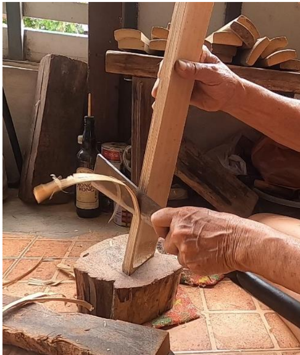
ภาพที่ 64 การตกแต่งในส่วนของด้านข้างของลูกระนาดท่อม เพื่อให้ลูกระนาดท่อมมีความตรงสวยงาม ที่มา: ปรีทัศน์ เรืองยิ้ม วันที่ 15 มิถุนายน 2563
