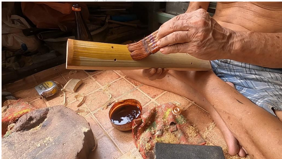
ภาพที่ 120 การทาสีแซลค์คบาง ๆ บริเวณบนลูกระนาดท่อม ที่มา: ปรีทศน์ เรืองยิ้ม วันที่ 15 มิถุนายน 2563
