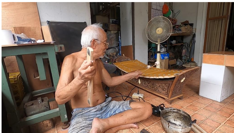
ภาพที่ 118 การเทียบเสียงกับผืนระนาดทุ้มที่ทำเสร็จแล้ว เพื่อให้ได้เสียงที่ตรงกัน ที่มา: ปรีทัศน์ เรืองยิ้ม วันที่ 15 มิถุนายน 2563
