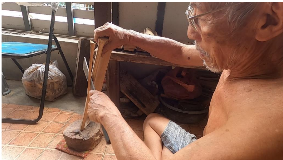
ภาพที่ 60 ขั้นตอนการใช้มีดผ่าให้ตรงตามเส้นที่ได้ขีดไว้ ที่มา: ปรีทัศน์ เรืองยิ้ม วันที่ 15 มิถุนายน 2563
