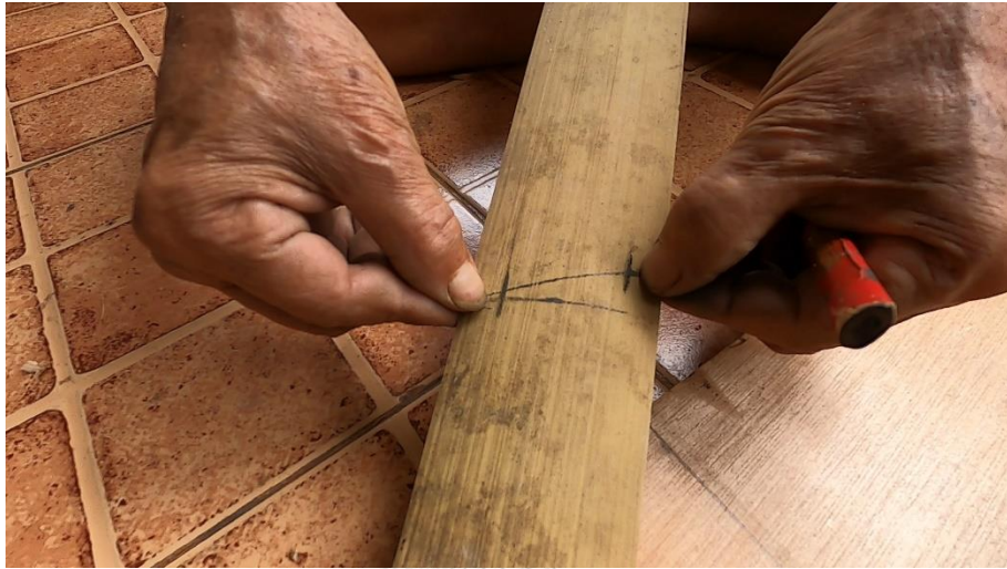
ภาพที่ 92 ตำแหน่งจุดเจาะรูร้อยเชือกที่วัดเสร็จแล้ว ที่มา: ปรีทัศน์ เรืองยิ้ม วันที่ 15 มิถุนายน 2563
