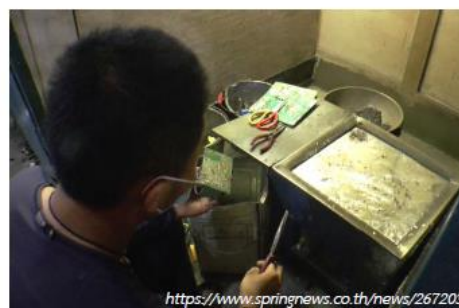
คนงานในโรงงานแห่งหนึ่งกำลังคัดแยกตะกั่วจากแผงวงจรอิเล็กทรอนิกส์โดยอาศัยความร้อน แต่ไม่ได้ทำในระบบปิด ส่งผลให้สารโลหะหนักสามารถแพร่กระจายสู่สิ่งแวดล้อมได้
