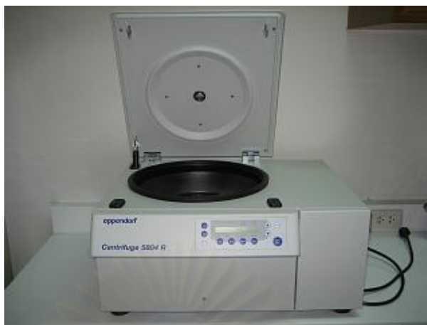
รูปที่ 23 แสดงเครื่อง centrifuge ที่ใช้ในการสกัด mRNA
