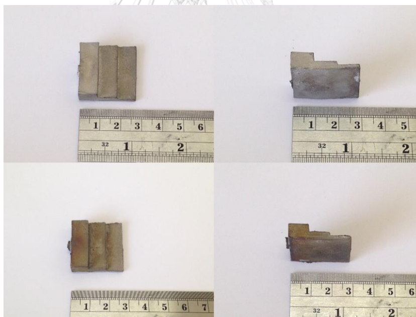
ภาพที่ 4.2 ชิ้นงานโลหะไทเทเนียมที่ผ่านกระบวนการหล่อ (บน) ไทเทเนียมบริสุทธิ์ (ล่าง) ไทเทเนียมผสม
