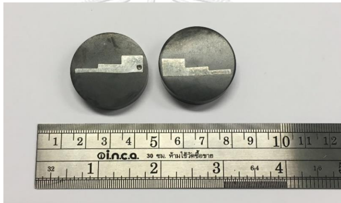
ภาพที่ 4.4 ตัวอย่างการเตรียมชิ้นงานสำหรับการตรวจสอบโครงสร้างจุลภาค
