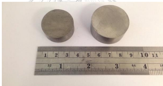
ภาพที่ 3.1 ลักษณะของโลหะที่ใช้ในการหล่อ (ซ้าย) โลหะไทเทเนียมบริสุทธิ์เกรด 2 (ขวา) โลหะผสมไทเทเนียมเกรด 5
