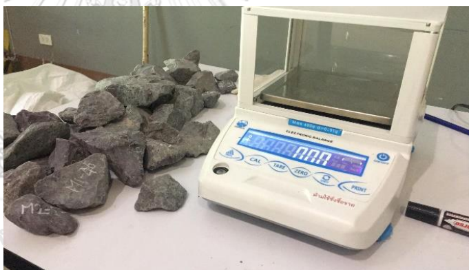
รูปที่ 23 การชั่งน้ำหนักหินโรยทางด้วยเครื่องชั่งน้ำหนัก
