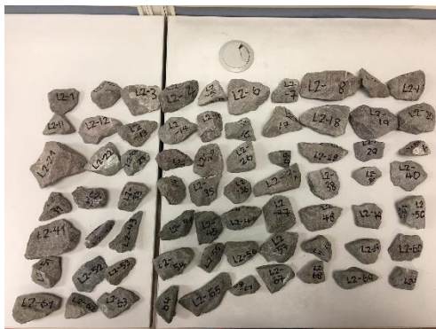
รูปที่ 22 การทำเครื่องหมายเพื่อแบ่งโซนของหินโรยทาง
