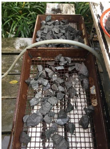
รูปที่ 18 การล้างทำความสะอาดหินโรยทาง
