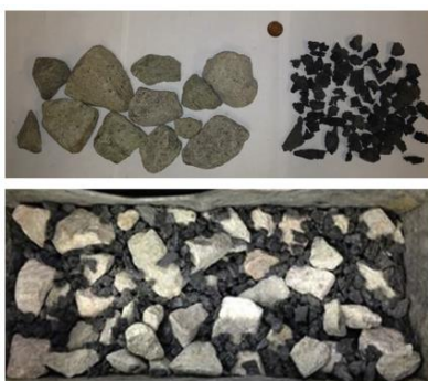
รูปที่ 14 หินโรยทางและการผสมวัสดุยางบดในกล่องอุปกรณ์ (M. Sol-Sánchez et al., 2015)
