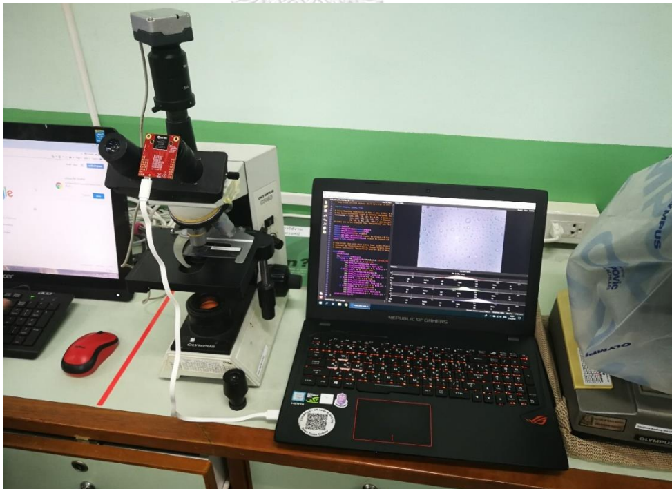
ภาพที่ 38 การทดสอบตัวรับรูภาพผ่านเครื่องคอมพิวเตอร์ ณ ห้องปฏิบัติการ ภาควิชาจุลชีววิทยา คณะสัตวแพทยศาสตร์ จุฬาลงกรณ์มหาวิทยาลัย
