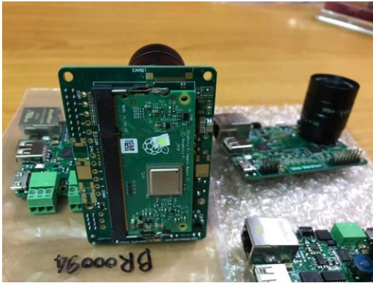
ภาพที่ 41 ชุดกล้อง EagleYE Smart Camera สำหรับงานด้าน Machine Vision และการเปลี่ยนชุดเลนส์ไปเป็น เลนส์สวมท่อส่งภาพแนวตั้ง และเลนส์กำลังขยาย 0.5X แบบ C mount
