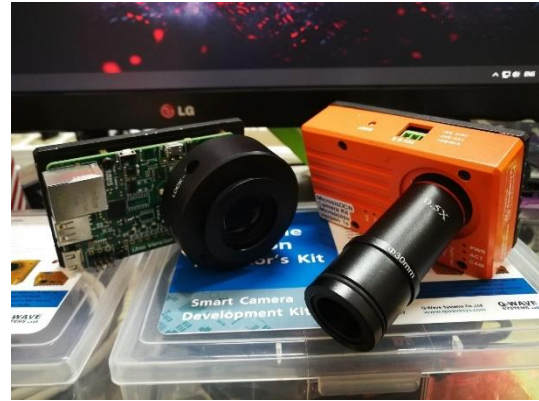
ภาพที่ 41 ชุดกล้อง EagleYE Smart Camera สำหรับงานด้าน Machine Vision และการเปลี่ยนชุดเลนส์ไปเป็น เลนส์สวมท่อส่งภาพแนวตั้ง และเลนส์กำลังขยาย 0.5X แบบ C mount
