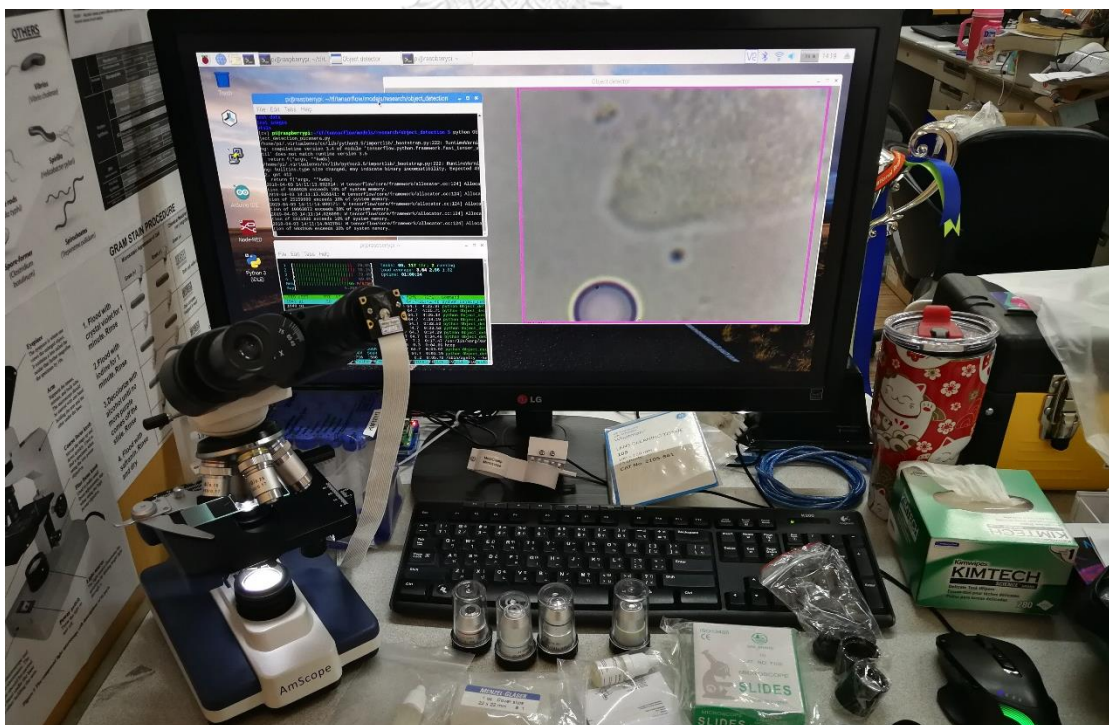
ภาพที่ 39 โมดูลกล้อง Raspberry Pi ถ่ายทอดสัญญาณผ่าน CSI cable สวมกับท่อเลนส์ใกล้ตา
