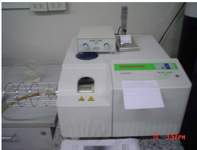
รูปที่ 3.13 เทอร์โมกราวิเมตริกแอนาไลเซอร์ METTLER TOLEDO รุ่น TGA/SDTA851
