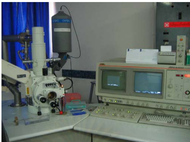
รูปที่ 3.15 กล้องจุลทรรศน์อิเล็กตรอนแบบส่องกราด รุ่น JSM-6400
