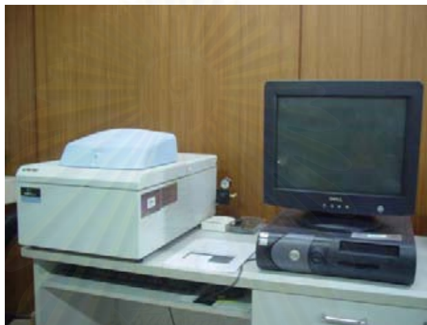
รูปที่ 3.12 ดิฟเฟอเรนเชียลสแกนนิ่งแคลอริมิเตอร์ Perkin Elmer รุ่น Diamond DSC
