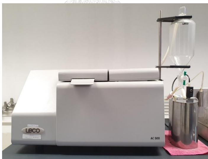
รูปที่ 3.7 เครื่องบอมบ์แคลอริมิเตอร์ (Bomb Calorimeter)
