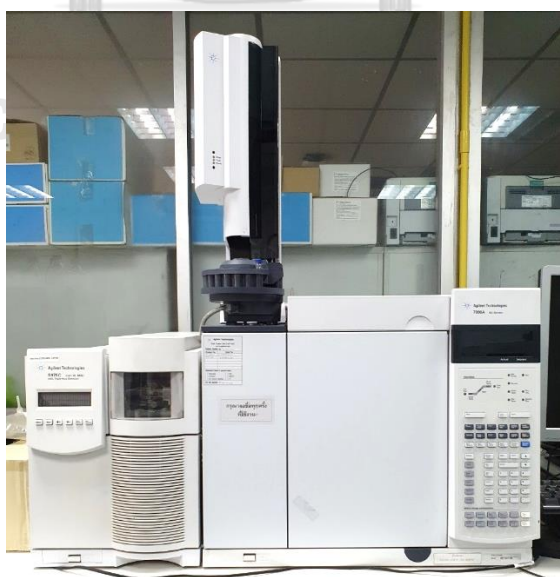
รูปที่ 3.5 เครื่องแก๊สโครมาโทกราฟีแมสสเปคโตรมิเตอร์ (Gas Chromatograph Mass Spectrometer, GC-MS)
