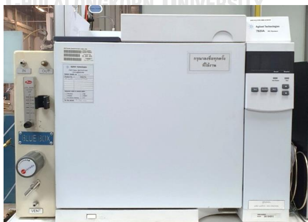
รูปที่ 3.3 เครื่องแก๊สโครมาโทกราฟี (Gas chromatography, GC-TCD)
