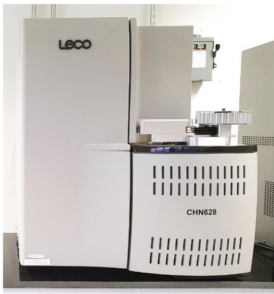
รูปที่ 3.6 เครื่องวิเคราะห์ธาตุ CNH (CHN analysis)
