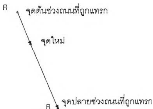
ภาพที่ 82 แสดงการแทรกช่วงจากจุดต้นช่วงไปจุดใหม่และจากจุดใหม่ไปจุดปลายช่วง
