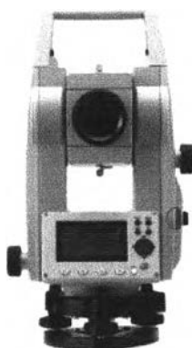
รูปภาพที่ 3.3 ภาพกล้องประมวลผลรวม Leica รุ่น TCR 405 (Leica Corp, 2003)
