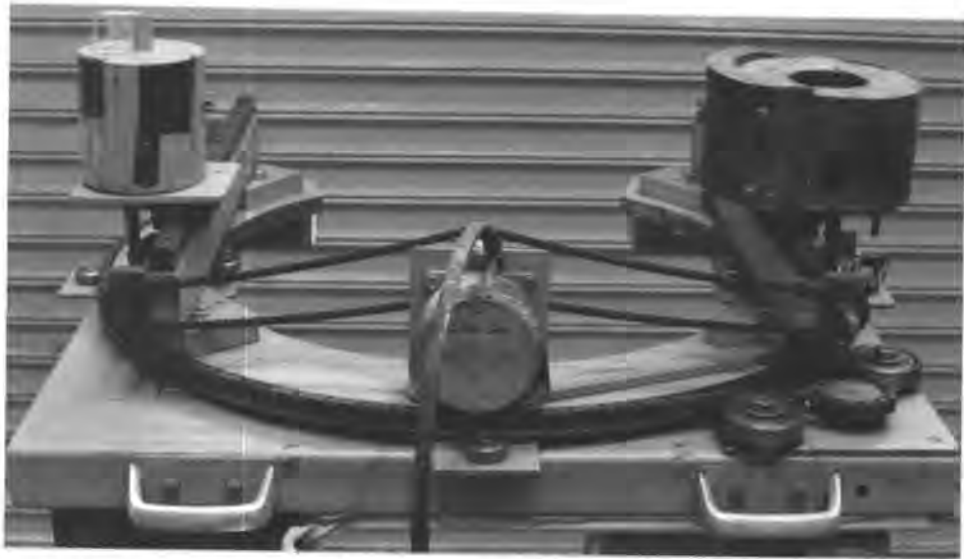
รูปที่ 3.8 ระบบขับเคลื่อนเพื่อเก็บข้อมูลสำหรับการคำนวณสร้างภาพโทโมกราฟี
