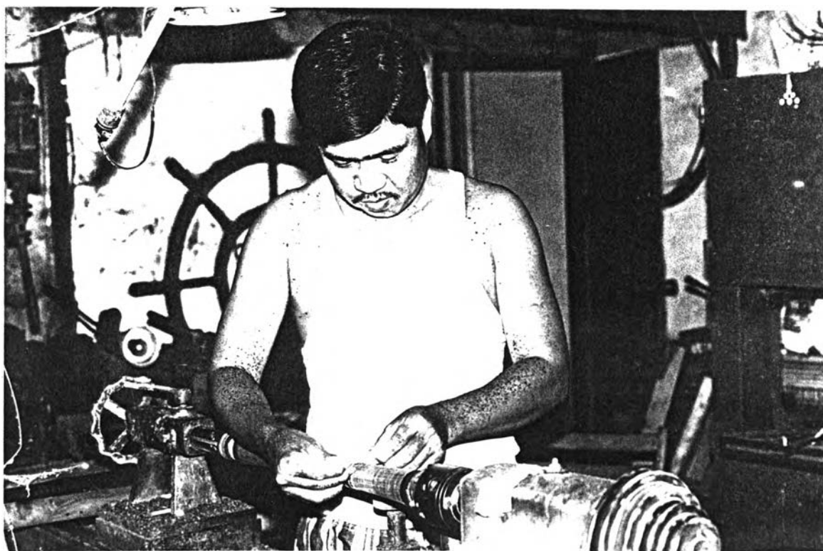
ภาพประกอบที่ 34 นำกระดาศทรายขัดเลาปี
