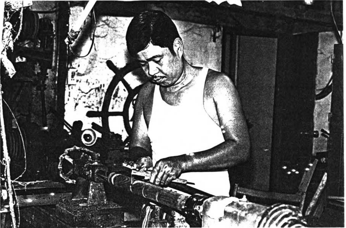
ภาพประกอบที่ 29 การกลึงเส้นลวดโดยแบ่งออกเป็น 3 ส่วน
