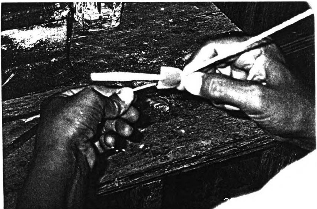
ภาพประกอบที่ 48 เสียบใบตาลเข้ากับกำพวดและไม้ฉนวน แล้วนำเชือกผูกเป็นเงื่อน ตะกรุดเบ็ด
