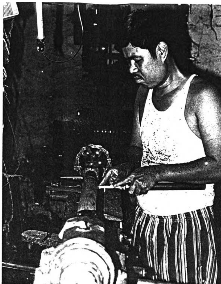
ภาพประกอบที่ 17 เข้าเครื่องกลึงไม้ให้กลมตลอดเลา
