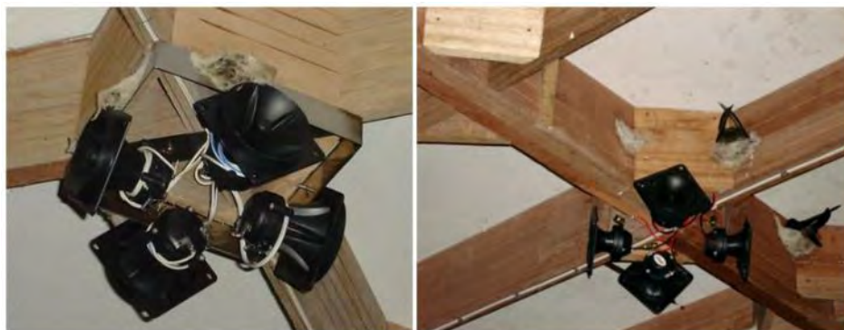
รูปที่ 68 ลำโพงเสียงกล่อมนกแอ่นภายในอาคาร (ฐิติพันธ์ วสุภาภิรมย์, 2552b)
