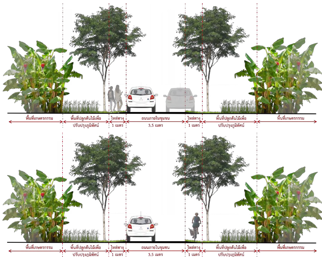
ภาพที่ 102 ถนนภายในชุมชนหลังปรับปรุง
