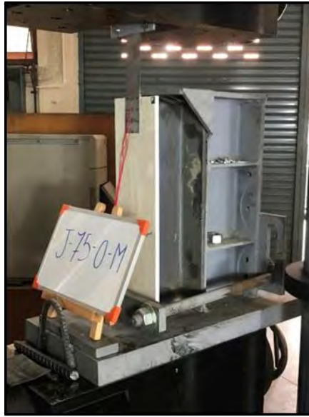
ข) ภาพถ่ายตัวอย่างการติดตั้งตัวอย่างกับโครงเหล็กประกอบ รูปที่ 19 (ต่อ) ตัวอย่างการติดตั้งตัวอย่างกับโครงเหล็กประกอบ
