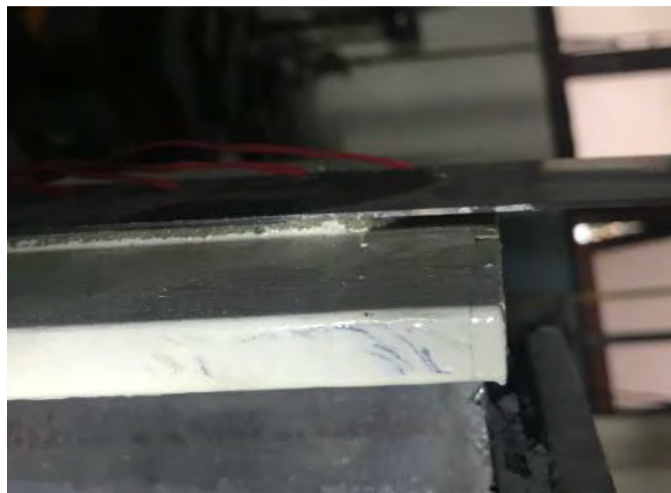
ข) ภาพถ่ายการติดตั้งวัสดุยึดประสานของตัวอย่างทดสอบที่มีวัสดุยึดประสานในตำแหน่งรอยร้าว เริ่มต้น
