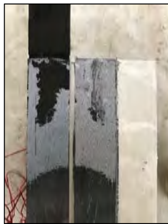
(ข.) การวิบัติรูปแบบ 2 ของตัวอย่าง J-150-0-M
