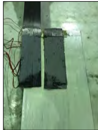
(ข.) การวิบัติรูปแบบ 2 ตัวอย่าง JA-150-25-S
