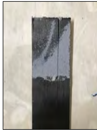
(ก.) การวิบัติรูปแบบที่ 1 ของตัวอย่าง J-75-0-M
