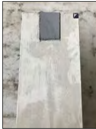
(ก.) การวิบัติรูปแบบที่ 1 ของตัวอย่าง J-75-0-M
