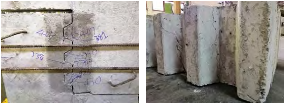
รูปที่ 4.35 การวิบัติของชิ้นตัวอย่าง 1SF-1
