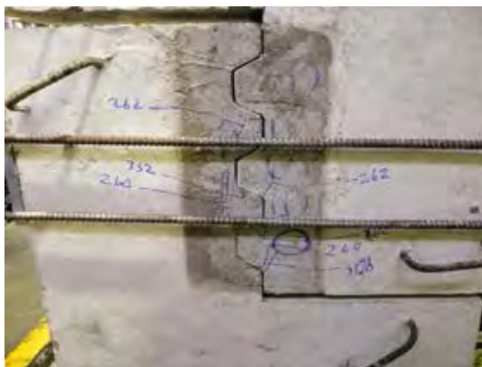
รูปที่ 4.34 การวิบัติของชิ้นตัวอย่าง 0.5SF-3
