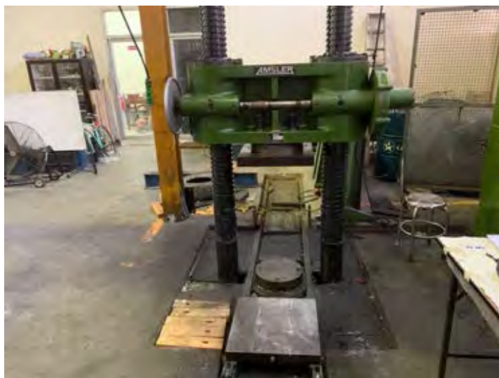
รูปที่ 3.9 เครื่องทดสอบแรงกด AMSLER 500T
