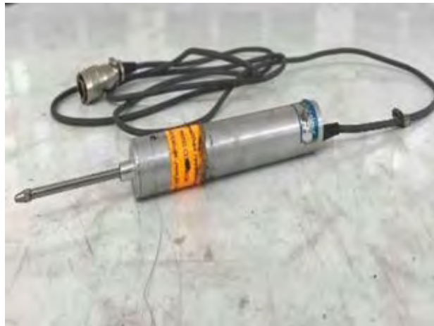
รูปที่ 3.12 อุปกรณ์วัดการเปลี่ยนตำแหน่ง
