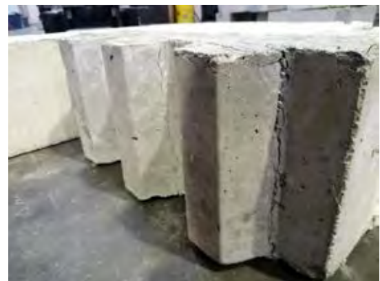
รูปที่ 4.34 การวิบัติของชิ้นตัวอย่าง 0.5SF-3
