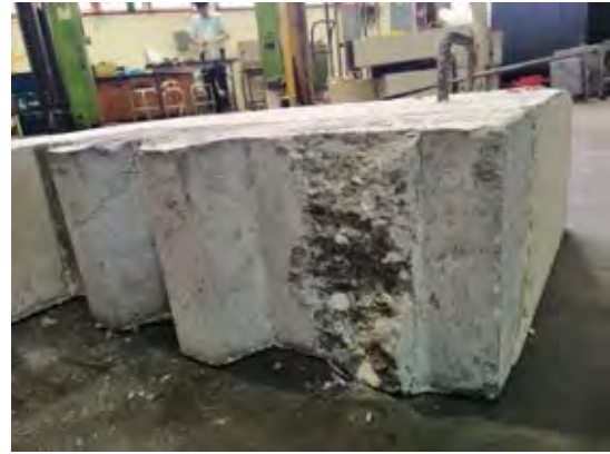
รูปที่ 4.29 การวิบัติของชิ้นตัวอย่าง HSC-1
