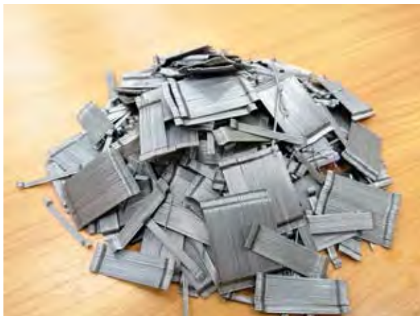
รูปที่ 3.3 เส้นใยเหล็กชนิด Dramix RC 65/35 BN
