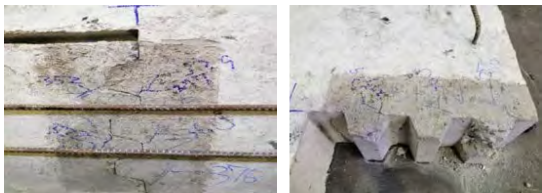
รูปที่ 4.28 การวิบัติของชิ้นตัวอย่าง NC-3
