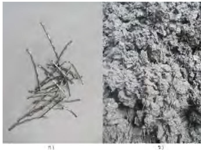
รูปที่ 2.24 ก.) ตัวอย่างเส้นใยเหล็ก ข.) คอนกรีตผสมเส้นใยเหล็ก [17]
