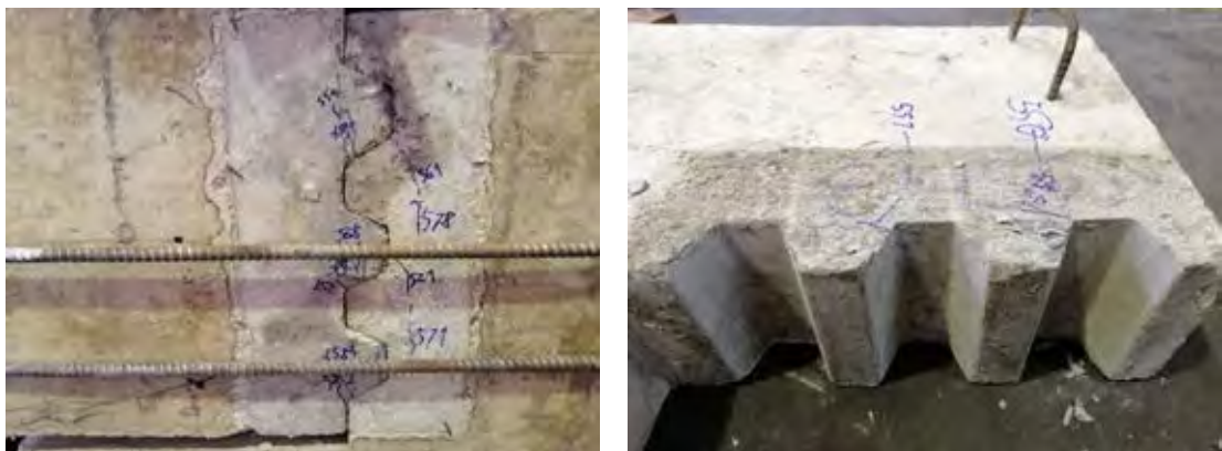
รูปที่ 4.37 การวิบัติของชิ้นตัวอย่าง 1SF-3
