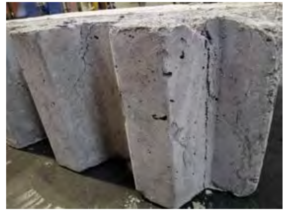
รูปที่ 4.32 การวิบัติของชิ้นตัวอย่าง 0.5SF-1
