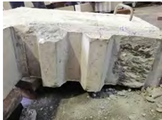
รูปที่ 4.31 การวิบัติของชิ้นตัวอย่าง HSC-3*
