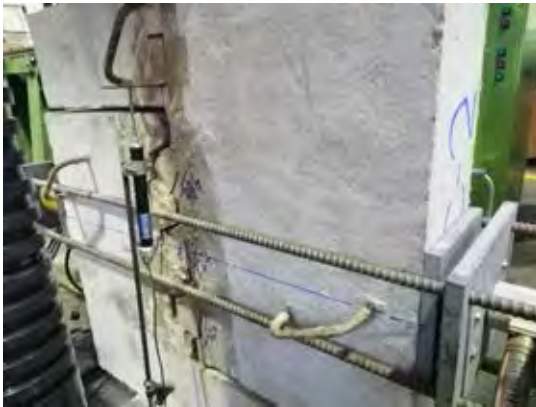
รูปที่ 4.30 การวิบัติของชิ้นตัวอย่าง HSC-2*
