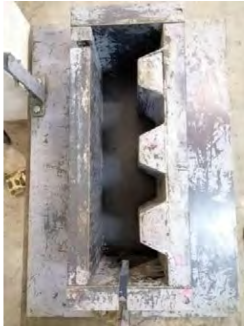
รูปที่ 3.4 แบบหล่อขึ้นส่วนรอยต่อพิเศษแบบแห้งหลายสลัก - สลักตัวผู้
