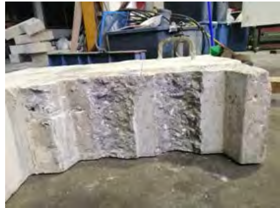
รูปที่ 4.30 การวิบัติของชิ้นตัวอย่าง HSC-2*
