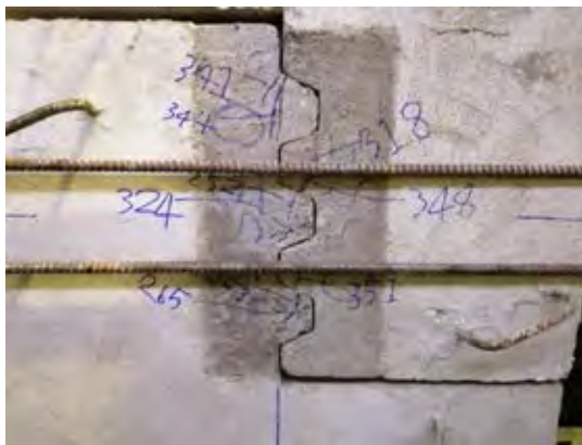
รูปที่ 4.33 การวิบัติของชิ้นตัวอย่าง 0.5SF-2
