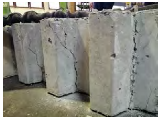
รูปที่ 4.33 การวิบัติของชิ้นตัวอย่าง 0.5SF-2
