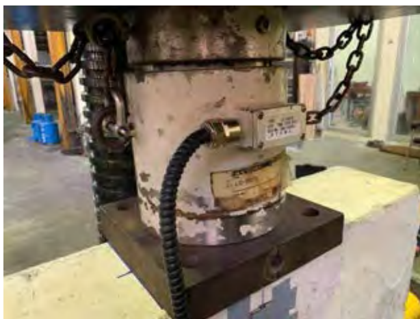
รูปที่ 3.11 เครื่องมือวัดหน่วยแรง โหลดเซลล์รับน้ำหนักขนาดพิกัด 200 ตัน
