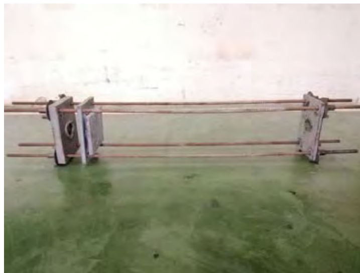
รูปที่ 3.15 โครงรับแรงสำหรับอัดแรงด้านข้างชิ้นส่วนทดสอบ
