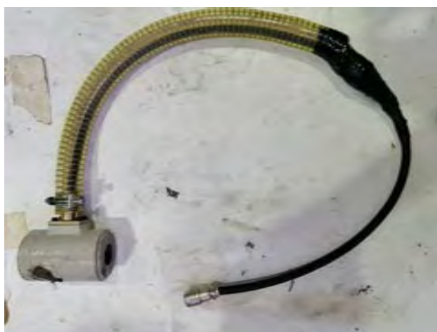
รูปที่ 3.10 เครื่องมือวัดหน่วยแรง โหลดเซลล์รับน้ำหนักขนาดพิกัด 30 ตัน
