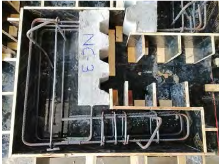
รูปที่ 3.6 แบบหล่อชิ้นส่วนตัวอย่างทดสอบก่อนเท
