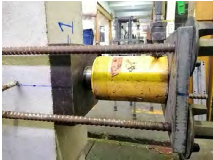
รูปที่ 3.16 แม่แรงไฮดรอลิคสำหรับต้นโครงรับแรงให้เกิดแรงด้านข้าง
