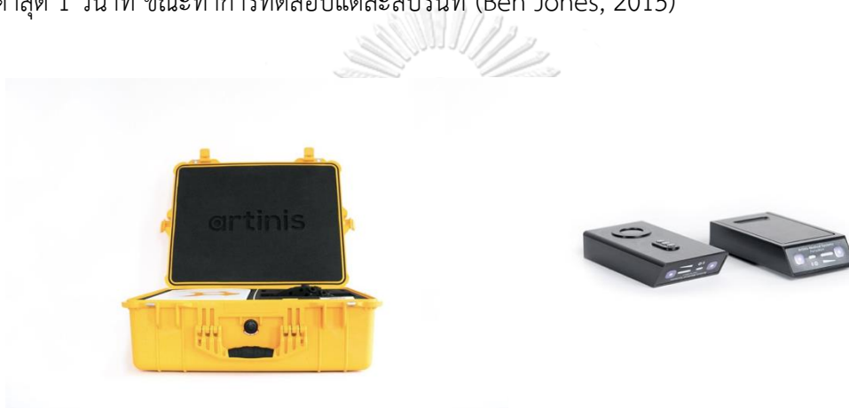
รูปเครื่องวิเคราะห์และอุปกรณ์เซ็นเซอร์ การใช้ออกซิเจนในเนื้อเยื่อ (Infrared Spectroscopy: NIRS)
