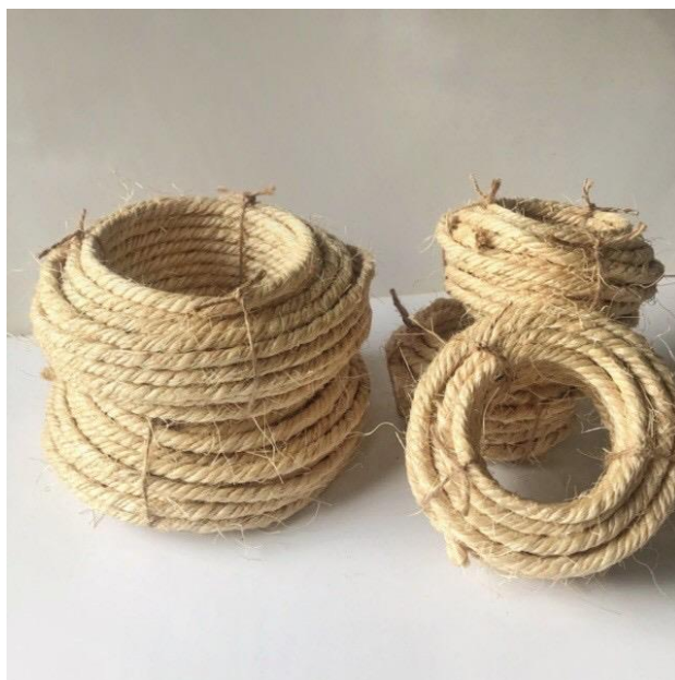
ภาพที่ 67 เชือกมะนิลา ขนาด 8 มิลลิเมตร ที่มา ผู้วิจัย
