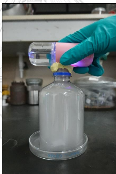
ภาพที่ 14 การฟั่นสารละลายเพอร์เมทรินด้วยเครื่องฟั่นละอองอัลตราโซนิกลงบนผ้า
