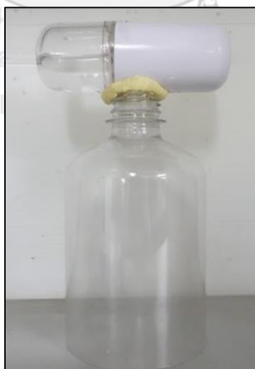
ภาพที่ 10 ติดตั้งกระบอกพ่นขนาดเส้นผ่านศูนย์กลาง 8 เซนติเมตรที่เครื่องพ่นละอองอัลตราโซนิก ด้วยกาวดินน้ำมัน
