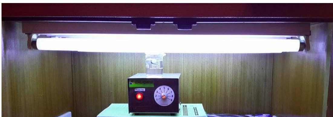
ภาพที่ 3.2 ชุดการทดลองฉายแสงยูวีเพื่อทดสอบการกำจัดพินอล
