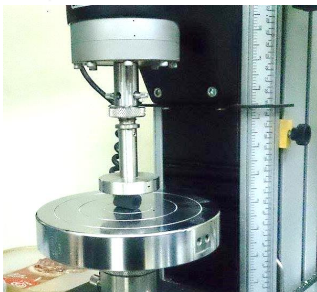
ภาพที่ 3.3 การทดสอบความแข็งแรงของชิ้นงานด้วย Universal Testing Machine (Instron5843)
