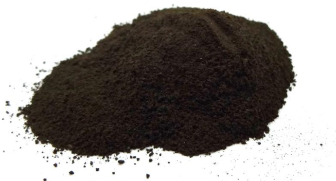
รูปที่ 9 LPC อบที่อุณหภูมิ 60 องศาเซลเซียส เป็นเวลา 24 ชั่วโมง
