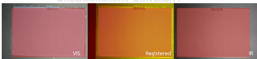
ภาพที่ 4.18 พื้นที่ใช้งานของระบบ Nikon J5 เลนส์ NIKKOR VR 10-30 มิลลิเมตร ที่ทางยาวโฟกัส 10 มิลลิเมตร แนวนอน สีเหลี่ยมสีแดงแสดงพื้นที่ใช้งานของกล้องปกติ (ซ้าย) กล้องดัดแปลงที่ติดตั้งฟิลเตอร์อินฟราเรด (ขวา) และภาพหลังการซ้อนภาพ (กลาง)
