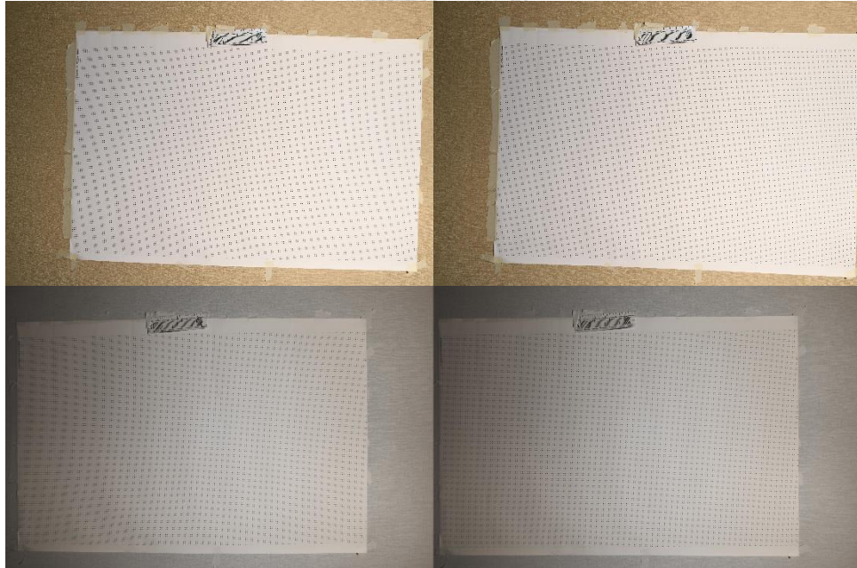
ภาพที่ 4.16 ตัวอย่างภาพก่อน (ซ้าย) และหลัง (ขวา) การแก้ไขความบิดเบี้ยวของเลนส์ Nikon 24 มิลลิเมตร บนกล้องปกติ (บน) และกล้องดัดแปลงที่ใส่ฟิลเตอร์อินฟราเรด (ล่าง)
