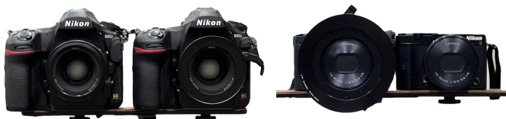
ภาพที่ 3.5 ระบบกล้องคู่แบบแนวนอนของกล้อง Nikon D850 (ซ้าย) และ Nikon J5 (ขวา)
