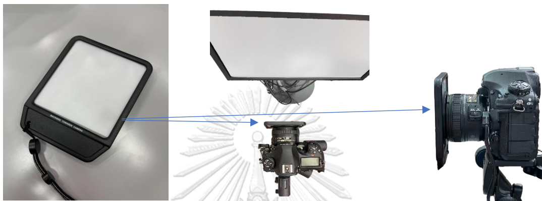
ภาพที่ 3.4 การติดตั้งแผ่นกระจายแสงสำหรับการถ่ายภาพเพื่อแก้ปัญหามืด
