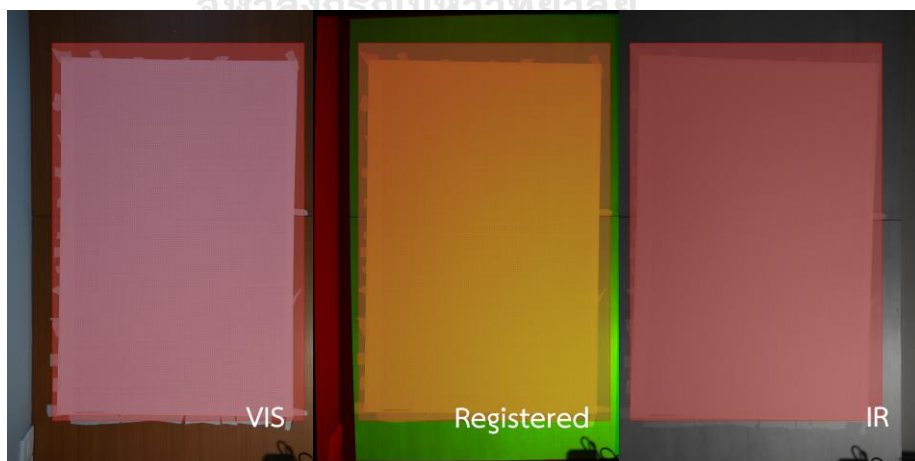
ภาพที่ 4.21 พื้นที่ใช้งานของระบบ Nikon J5 เลนส์ NIKKOR VR 10-30 มิลลิเมตร ที่ทางยาวโฟกัส 18 มิลลิเมตร แนวตั้ง สีเหลืองสีแดงแสดงพื้นที่ใช้งานของกล้องปกติ (ซ้าย) กล้องดัดแปลงที่ติดตั้งฟิลเตอร์อินฟราเรด (ขวา) และภาพหลังการซ้อนภาพ (กลาง)
