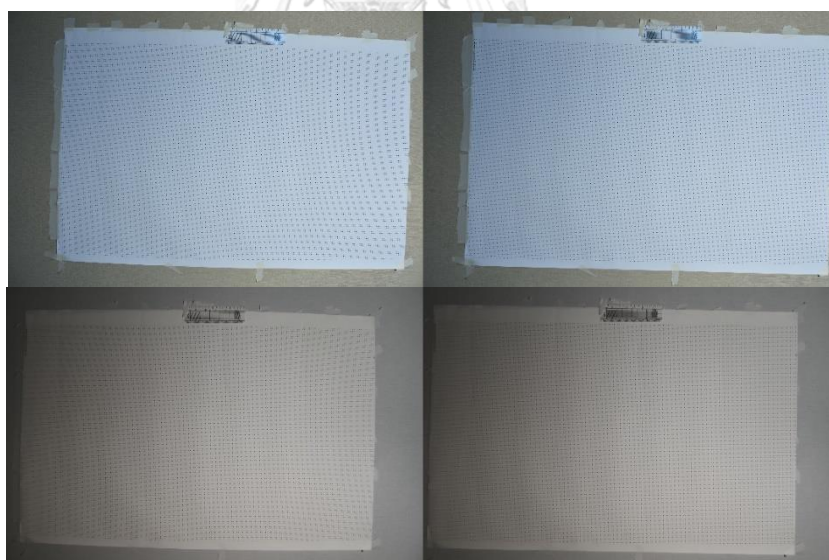
ภาพที่ 4.14 ตัวอย่างภาพก่อน (ซ้าย) และหลัง (ขวา) การแก้ไขความบิดเบี้ยวของเลนส์ NIKKOR VR 10-30 มิลลิเมตร ที่ทางยาวโฟกัส 10 มิลลิเมตร บนกล้องปกติ (บน) และกล้องตัดแปลงที่ใส่ฟิลเตอร์อินฟราเรด (ล่าง)
