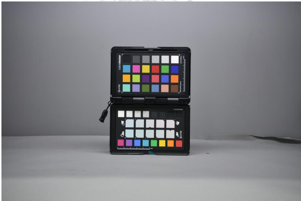
ภาพที่ ก.2 ภาพที่ใช้ทดสอบหาอัตราส่วนสัญญาณต่อสัญญาณรบกวนของกล้อง Nikon J5
