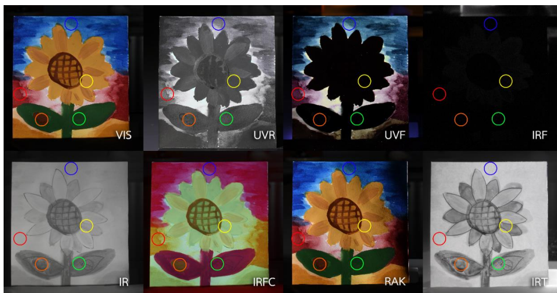
ภาพที่ 4.30 พื้นที่ที่ใช้ในการระบุสารสีด้วยวิธีแผนผังจำแนกจากระบบกล้องเดียว วงกลมแต่ละสีแสดงพื้นที่ที่ใช้ในการระบุสารสีสีนั้น
