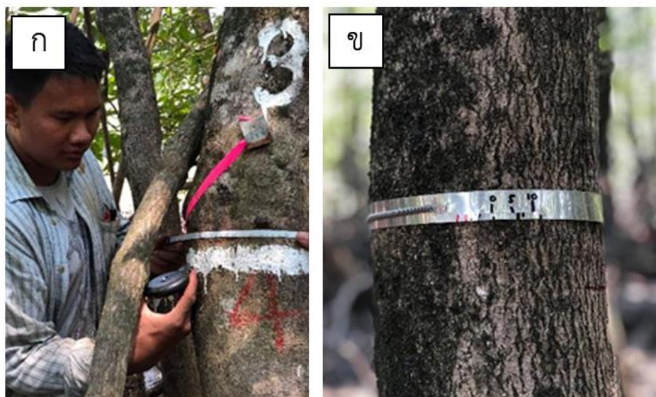
ภาพที่ 6 การบันทึกขนาด DBH ก่อนติดตั้งแถบ dendrometer บนลำต้นแสมขาว ( A. alba ) (ก) และแถบ dendrometer ที่ติดตั้งแล้วบนต้นแสมขาว ( A. alba ) (ข)
