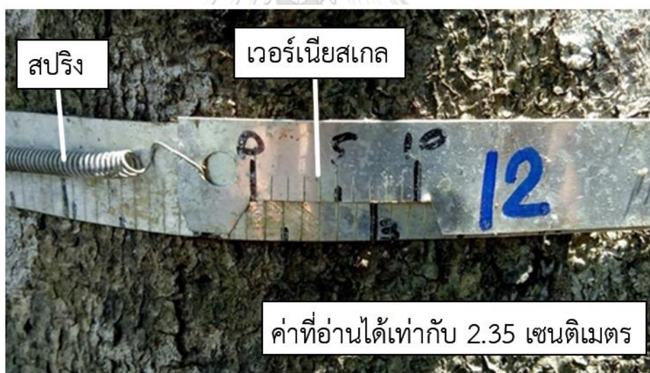
ภาพที่ 7 เวอร์เนียสเกลที่อยู่บนแถบ dendrometer และตัวอย่างการอ่านค่าจากสเกล
