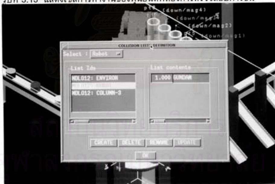
รูปที่ 3.14 แสดงการกำหนด "Collision List Definition"
