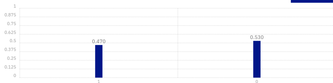
ภาพที่ 4 ผลลัพธ์ของวงจรสร้างสถานะซูเปอร์โพสิชันของคิวบิตในภาพที่ 3 [5]
