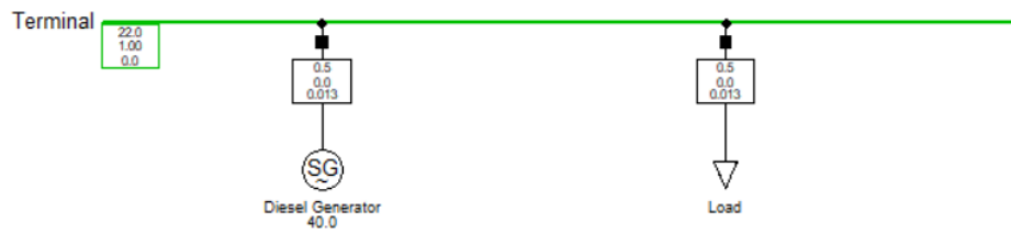
รูปที่ 3.6 ระบบไฟฟ้าสำหรับการจำลองการทำงานของตัวควบคุมป้อนภูมิของเครื่องกำเนิดไฟฟ้าดีเซล
