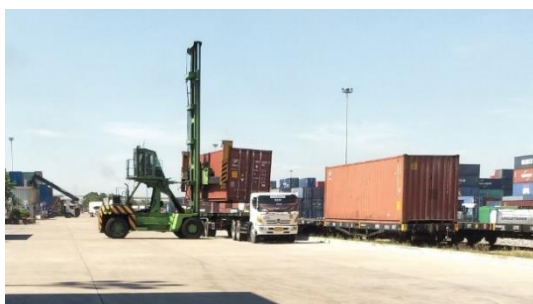
รูปภาพที่ 2.5 การยกตู้คอนเทนเนอร์ขึ้นบรรทุกในรถไฟ
