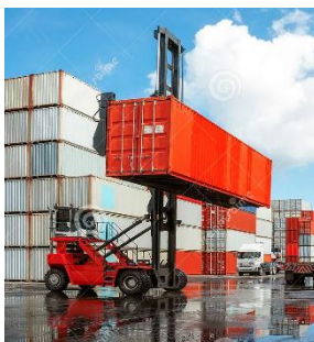
รูปภาพที่ 2.2 รถเครนสำหรับยกตู้เปล่า (www.dreamstime.com)
