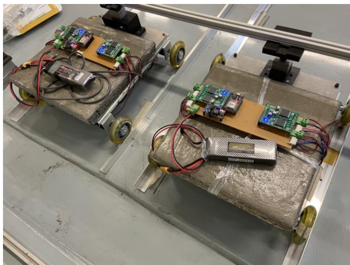
รูปที่ 5.10 เพิ่มน้ำหนักให้หุ่นยนต์แต่ละตัวแต่ละ 8 กิโลกรัม
