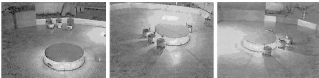
รูปที่ 2.1 ตัวอย่างงานวิจัยที่ใช้ระบบหุ่นยนต์หลายตัวเคลื่อนย้ายวัตถุด้วยการผลัก [14]
