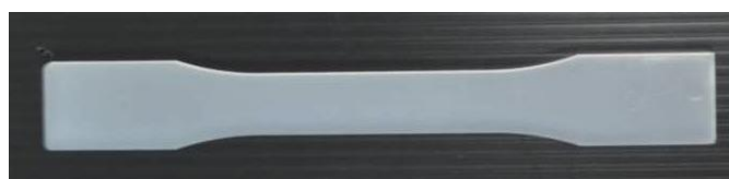
รูปที่ 3. 15 ชิ้นทดสอบรูปดัมเบลล์ตามมาตรฐาน ASTM D 638 type 1
