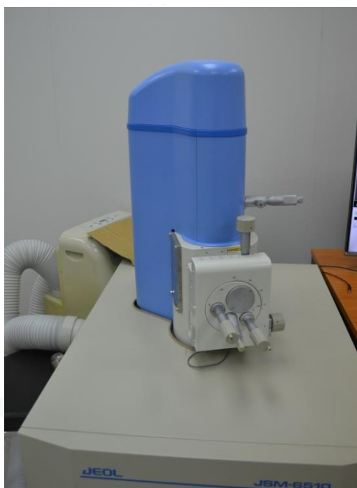
รูปที่ 3. 8 กล้องจุลทรรศน์อิเล็กตรอนแบบส่องกราด (Jeol JSM 6510)
