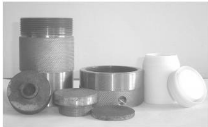
รูปที่ 2. 21 ออโตเคลฟและภาชนะที่ภายในบุด้วยเทฟลอนที่ใช้ในกระบวนการไฮโดรเทอร์มัล[11]
