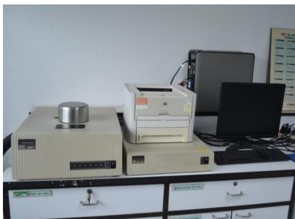
รูปที่ 3. 14 เครื่องดีฟเฟอเรนเชียลสแกนนิ่งแคลอริมิเตอร์
