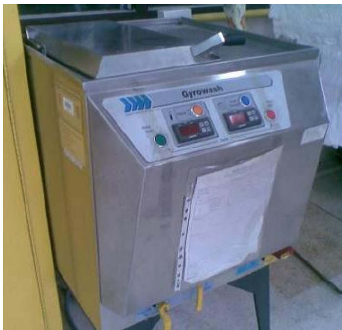
รูปที่ 3. 13 เครื่อง Gyrowash สำหรับทดสอบความคงทนของผ้าตัวอย่างต่อการซักล้าง รุ่น Gyrowash 815/20 ของบริษัท James H. Heal & Co., Ltd.
