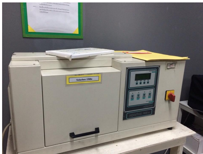
รูปที่ 3. 16 เครื่อง Solarbox 1500e สำหรับทดสอบความคงทนของผ้าตัวอย่างต่อแสง ร้อน 1500e RH ของบริษัท CO.FO.ME.GRA.
