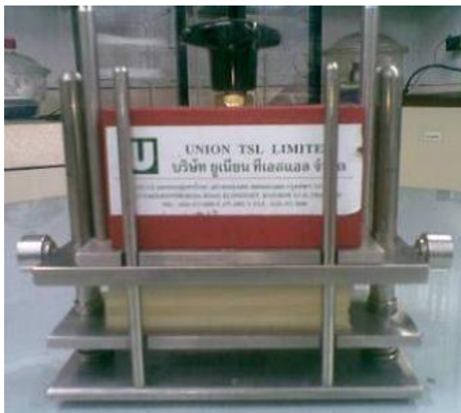
รูปที่ 3.14 เครื่อง Perspirometer สำหรับทดสอบความคงทนของผ้าตัวอย่างต่อเหงื่อ รุ่น M231 ของบริษัท SDL Atlas Inc.
