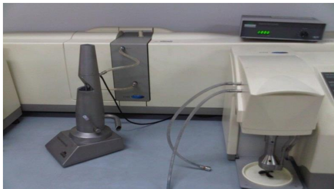
รูปที่ 3. 6 เครื่อง Laser Particle Size Distribution Analyzers และหน่วยการกระจาย Hydro 2000SM รุ่น Mastersizer 2000 ของบริษัท Malvern
