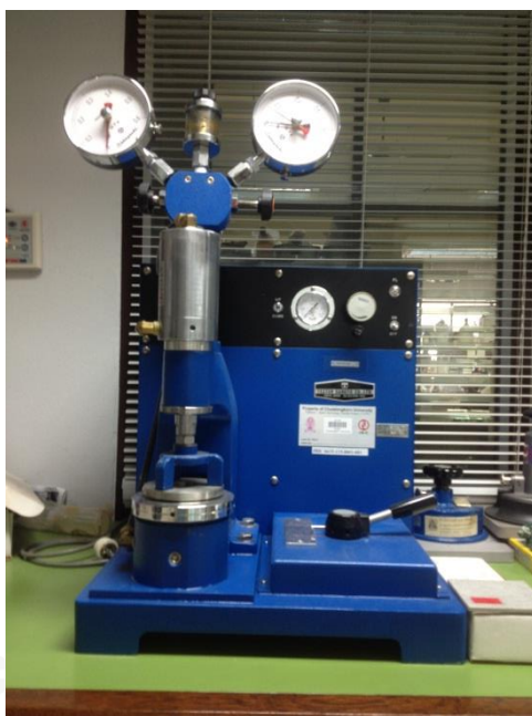
รูปที่ 3. 10 เครื่องทดสอบความต้านทานต่อแรงดันทะลุของผ้า รุ่น CY-6103A1 ของบริษัท Chun Yen Testing Machines Co., Ltd.
