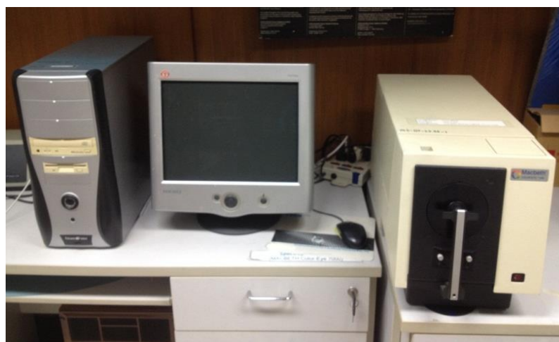
รูปที่ 3. 12 เครื่องวัดสีผ้า รุ่น Macbeth color-eye 7000 ของบริษัท X-Rite, Incorporated
