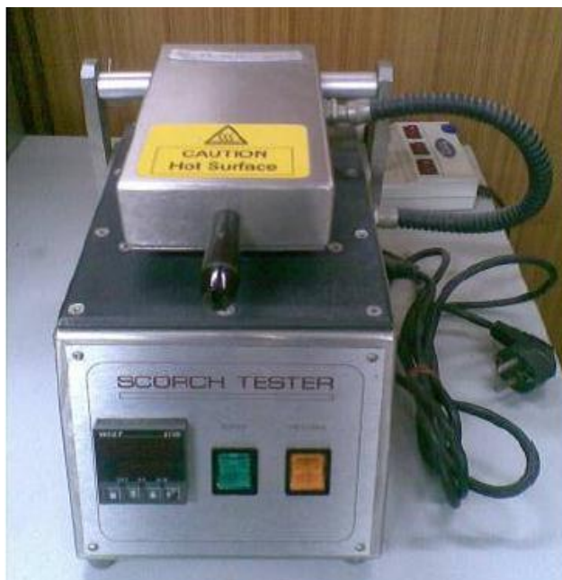
รูปที่ 3. 15 เครื่อง Scorch tester สำหรับทดสอบความคงทนของผ้าตัวอย่างต่อการรีดร้อน รุ่น M247A ของบริษัท SDL Atlas Inc.
