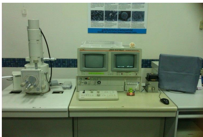
รูปที่ 3. 5 กล้องจุลทรรศน์อิเล็กตรอนแบบส่องกราด รุ่น JSM 5410 LV ของบริษัท JEOL., Ltd.
