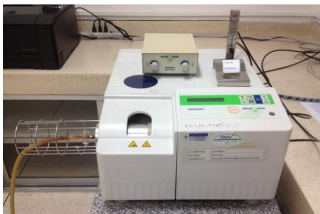
รูปที่ 3. 7 เครื่อง TGA รุ่น TGA/SDTA851e ของบริษัท Mettler Toledo
